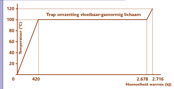
Diagram met de respectievelijke warmtehoeveelheden die 1 kg water op 0°C nodig heeft om naar de toestand van oververhitte stoom op 120°C over te gaan
