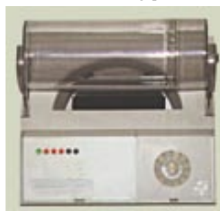
Fig. 47: Deze ventilatiemonitor blaast verse lucht in het kantoor, enkel wanneer iemand aanwezig is. Bovendien wordt het debiet aangepast aan het aantal aanwezigen. De elektrische voeding voor de detectie en de bediening van de klep wordt geleverd door een klein batterijtje. In het PROBE-gebouw met zijn wisselende bezetting leidde de toepassing van dit vraaggestuurd systeem tot een besparing van 35% op de verwarming voor ventilatie t.o.v. een systeem met constant debiet tijdens de kantooruren.
