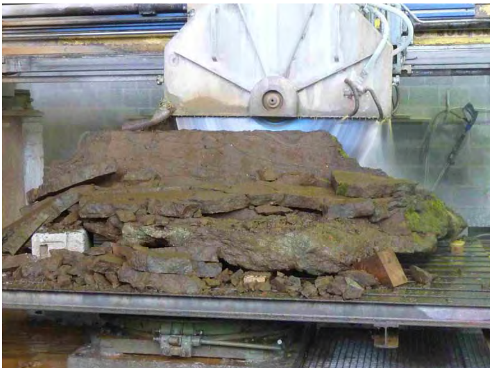
Figuur 55. Gedeeltelijk uit elkaar vallen van de blok ijzerzandsteen tijdens het verzagen.
