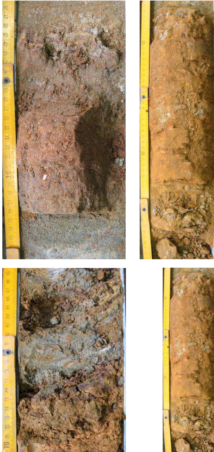
Figuur 22. Detailfoto's van de verhardingen (ijzerzandsteen) aangetroffen in de kernen, door M. Duser (BGD): respectievelijk (van links naar rechts en van boven naar onder): B4K7645, B4K8750, K12 1185, K13 1240.
