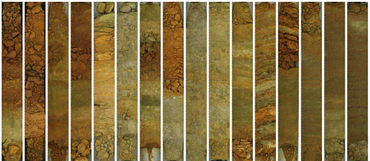
Figuur 24. Compilatie van 16 volledige opnames met de corescanner van de opeenvolgende boorkernen (1m) van boring B4 (VITO).
