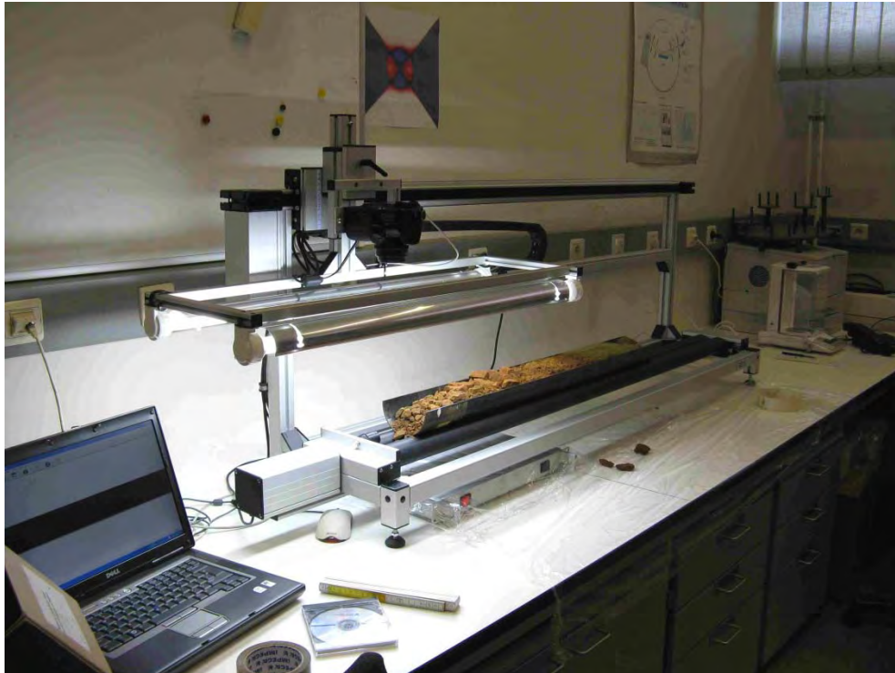
Figuur 23. Corescanner (VITO) met doorgesneden kernbuis en inhoud.
