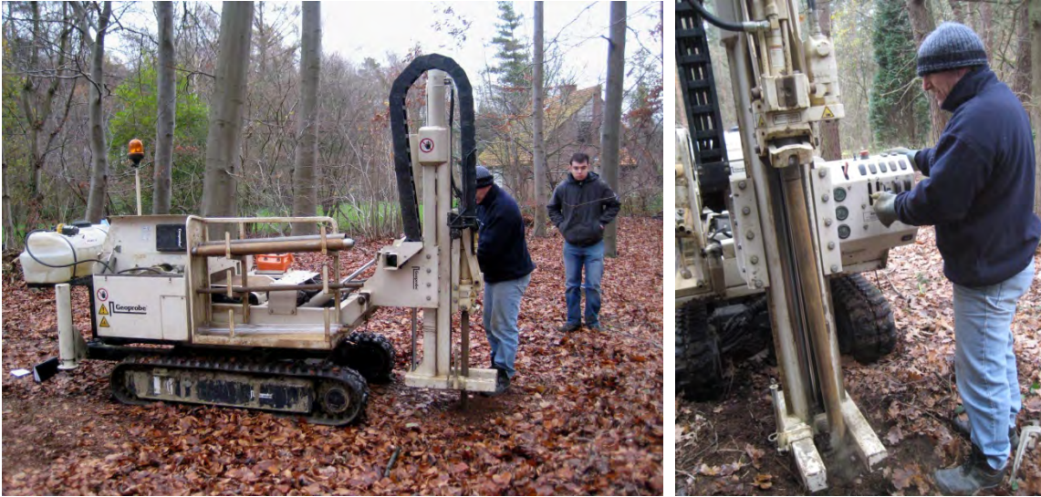
Figuur 47. Boring met het Geoprobe-toestel in uitvoering.
