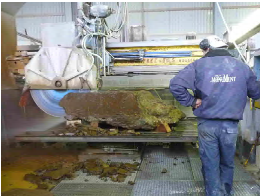
Figuur 54. Verzagen van het blok ijzerzandsteen door Monument nv.
