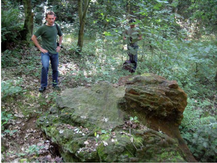
Figuur 43. Losliggende blok ijzerzandsteen afkomstig van het talud. Deze blok werd opgehaald door Monument nv en verzaagd tot blokjes voor verdere testen.
