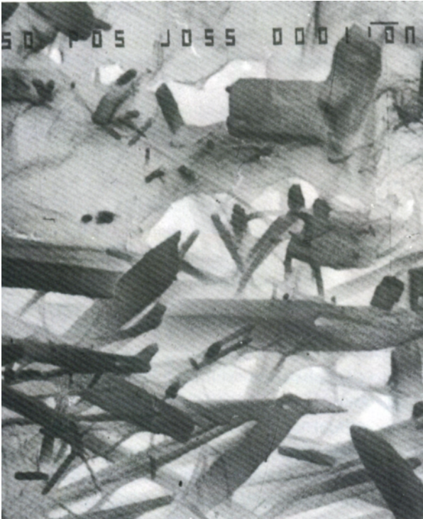
AFB. 2.6 SCANNING ELECTRONEN MICROSCOOP Electronen microscoop-opname van mulliet-kristallen. Mulliet wordt gevormd tijdens het bakken bij temperaturen hoger dan 1000°C.
