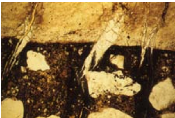
Afb. 3.1 VERWERING VAN BETON Door de reactie met het bindmiddel (donkerbruine massa) is de vuursteenkei (het lichtbruine aan de bovenkant van de foto) over heel het contact gearsten door de ontwikkeling van het zwellende natriumsilicaat (heldere slierten).
