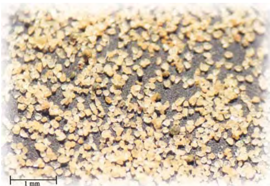
Zeer fijn zand van het Lid van Neerrepen. Vindplaats: Kesselberg, Leuven. Goede sortering: vrij uniforme korrelgrootte.
