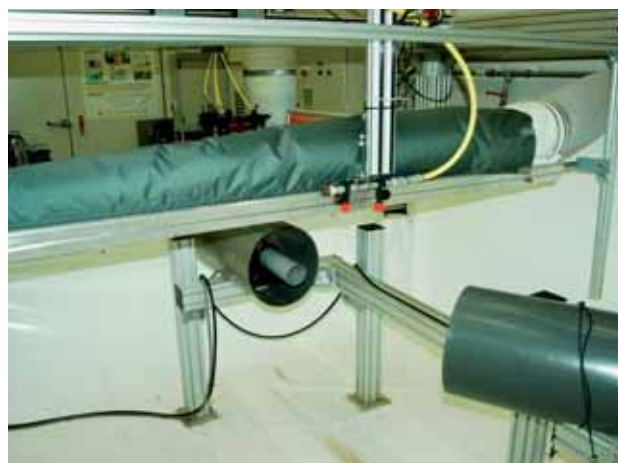
De labo-opstelling voor het onderzoek naar het effect van luchtondersteuning. (Foto: ILVO)
