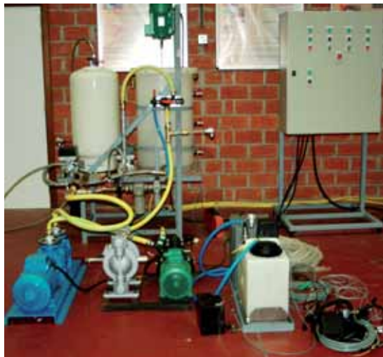
De modulaire proefopstelling bevat drie mengsystemen, drie verschillende pomptypes, een injectiesysteem en een beweegbare spuitboom met vijf spuitdoppen.
