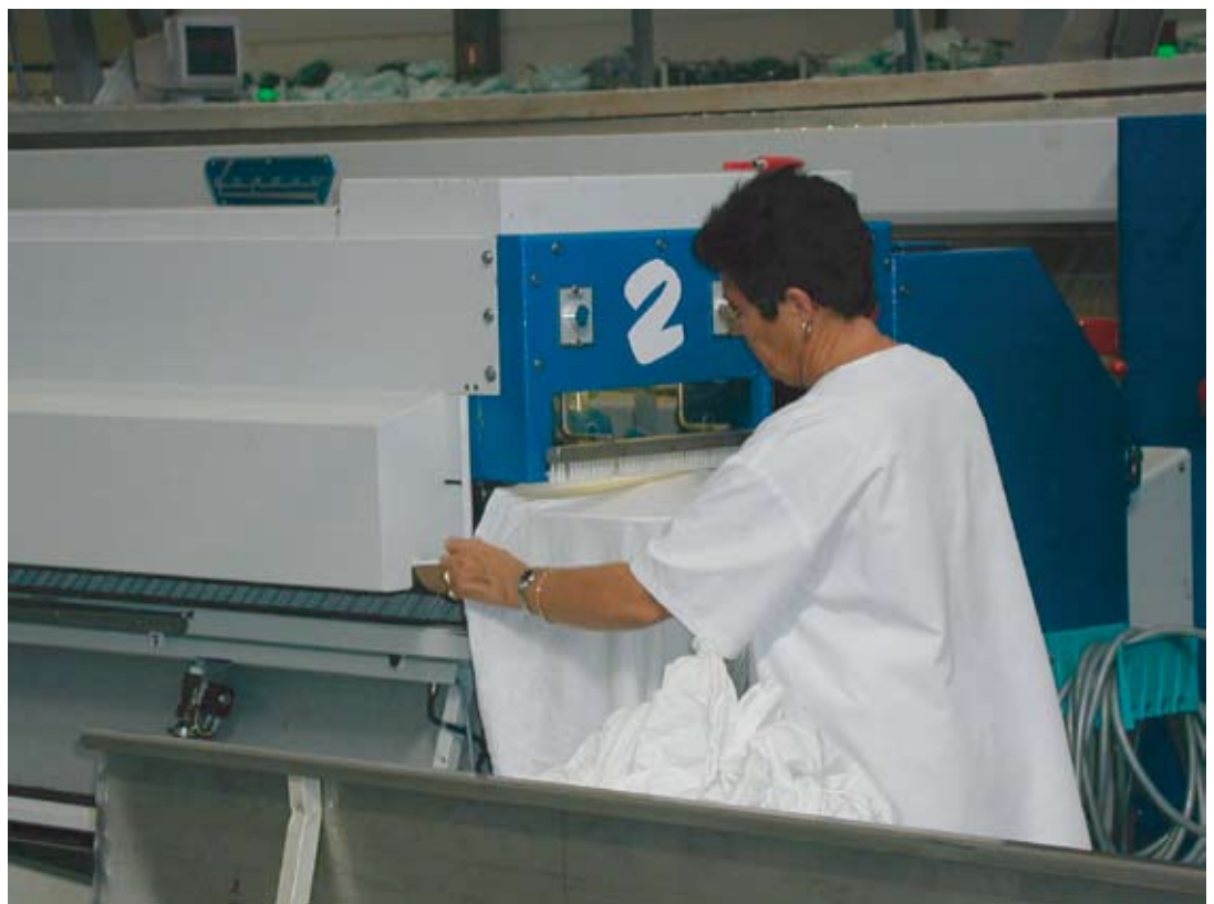
Figuur 19: Optimale belegging door middel van insteekapparatuur (bron: FBT innovatiecel).
