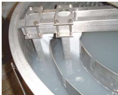
Figuur 12: Bij deze warmtewisselaar wordt het vers water door de tussenwanden en buitenwand gestuurd. Het afvalwater wordt door roterende borstels in turbulentie gehouden, waardoor de platen zuiver gehouden worden (bron: Christeyns).
