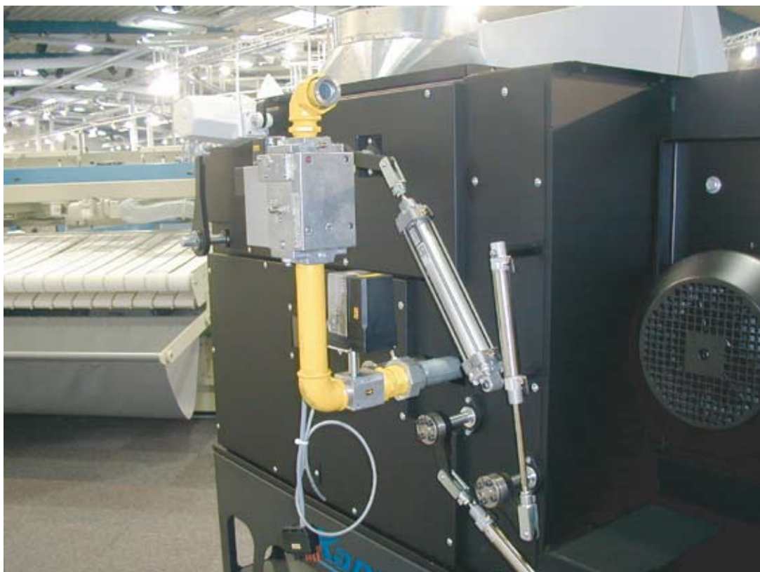
Figuur 22: Rechtstreekse aardgasverwarming op tumblerdroger (bron: FBT-innovatiecel).
