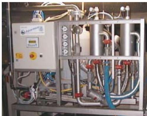
Figuur 14: Filtersysteem van 75 \mu m en 25 \mu m-filtratie uitgerust met automatische terugspoeling. Inzetbaar op wastunnels of centrifugerende wasmachines (bron: Ecolab).
