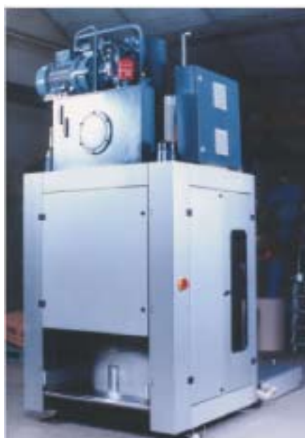
Figuur 6: Een hogere persdruk leidt tot een verlaging van het restvochtgehalte van het textiel na het persen (bron: Habuco).
