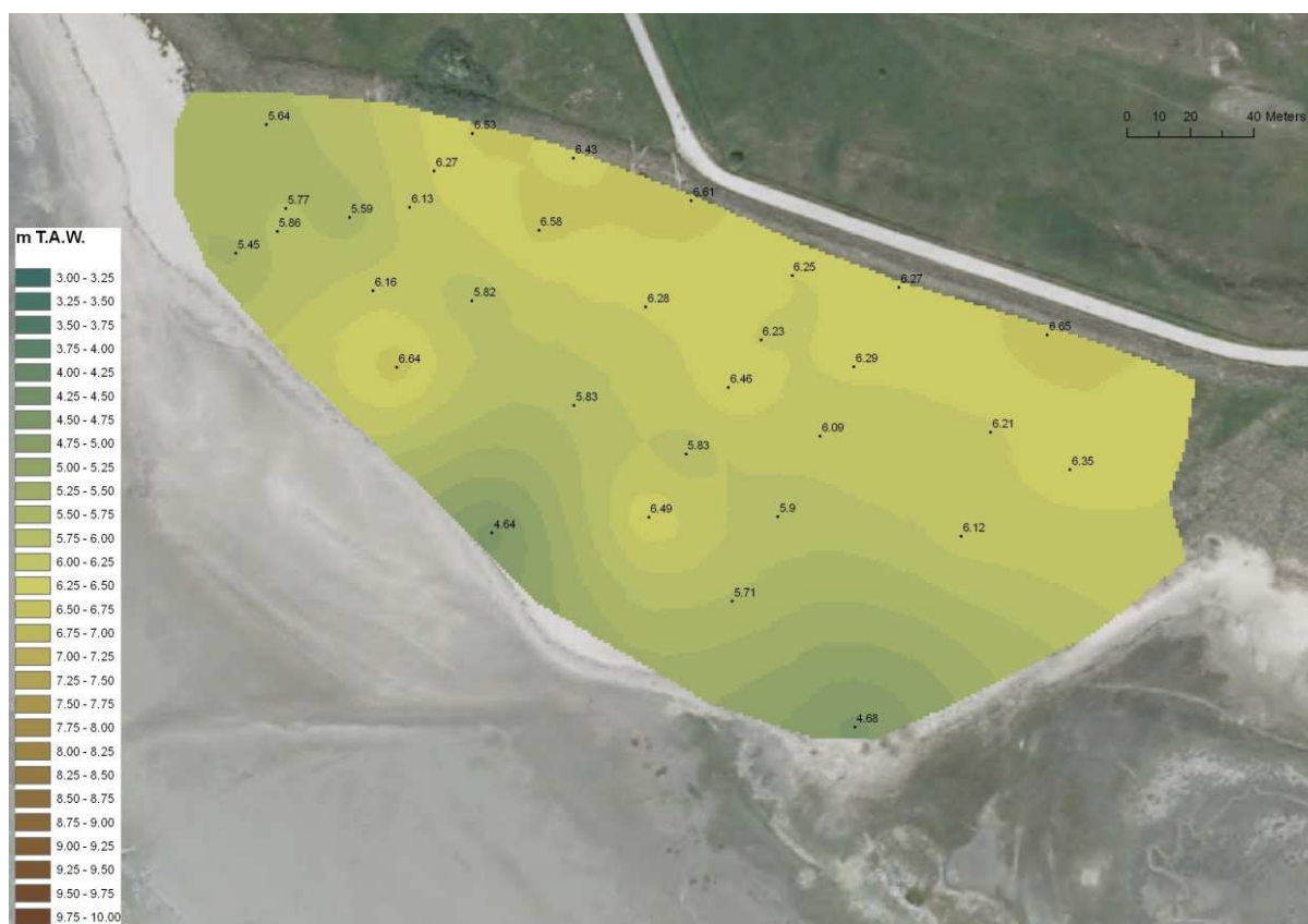
Figuur 7. Hoogte van de onder- en bovenzijde van de aangeboorde 'centrale kleilaag'.
