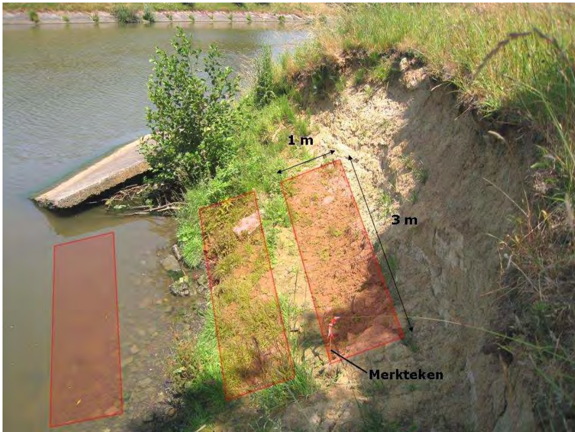
Figuur 3: Transect bestaande uit 3 plots loodrecht op de vooroever. De rechthoek van de bovenste plot is gemarkeerd met behulp van een betonijzer voorzien van veiligheidslint.
