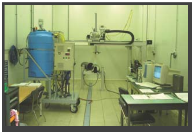
PDPA-laser meetopstelling voor het opmeten van druppelsnelheden en -groottes van spuitdoppen
