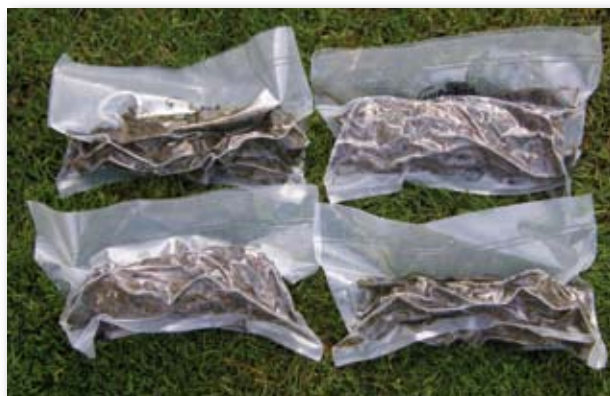
Labschaal silages gemaakt door de gewassen vacuüm te verpakken in polyethyleen zakken
