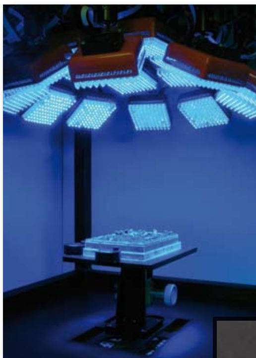
Foto 1: Meting van chlorofylfluorescentie bij industriële cichorei via de CFImager (Technologica, UK)
