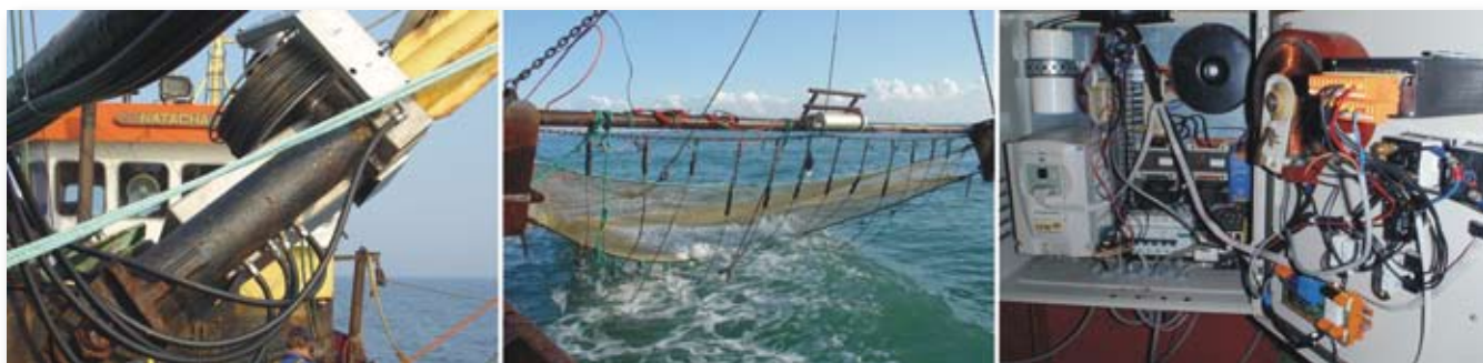
Figuur 7: Geïnstalleerde apparatuur aan boord van het testvaartuig; van links naar rechts: elektrische kabellier; pulskor met pulsgenerator; schakelkast
