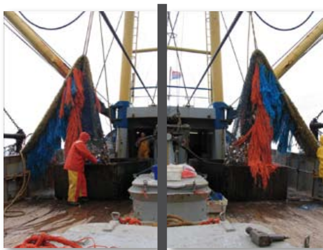
Foto vangstvergelijking: Experimentele opzet bij het testen van een SMCE en BRP: aan bakboord een standaard net zonder aanpassingen; aan stuurboord een aangepast net met SMCE en/of een BRP. De vangsten van beide kanten werden gescheiden geanalyseerd
