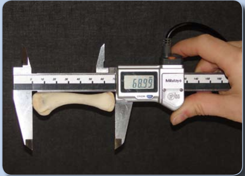
Metten van botlengte met een elektronische schuifmaat
