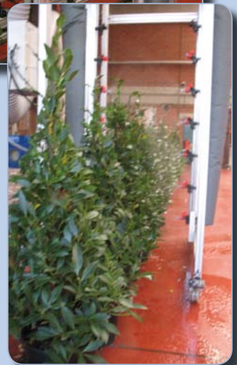
Alternatieve behandeling van sierlaurier m.b.v. tunnelspuit
