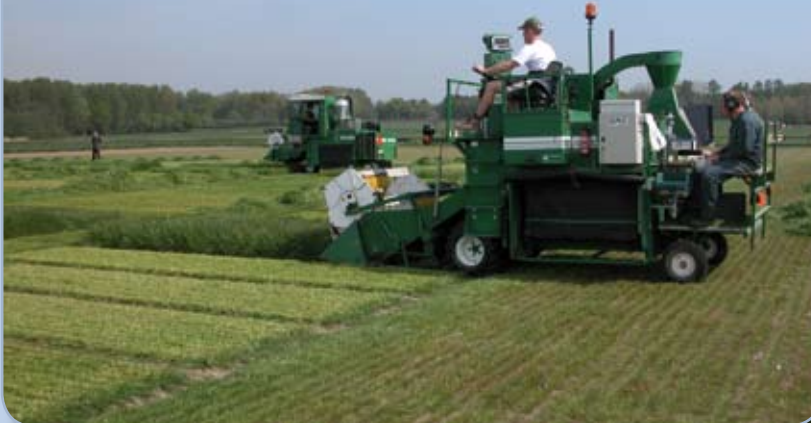
Opbrengst en kwaliteitsbepaling met groenvoederproefveldoogstmachine
