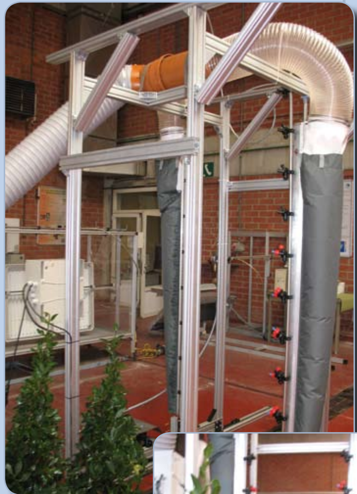
Alternatieve behandeling van sierlaurier m.b.v. tunnelspuit
