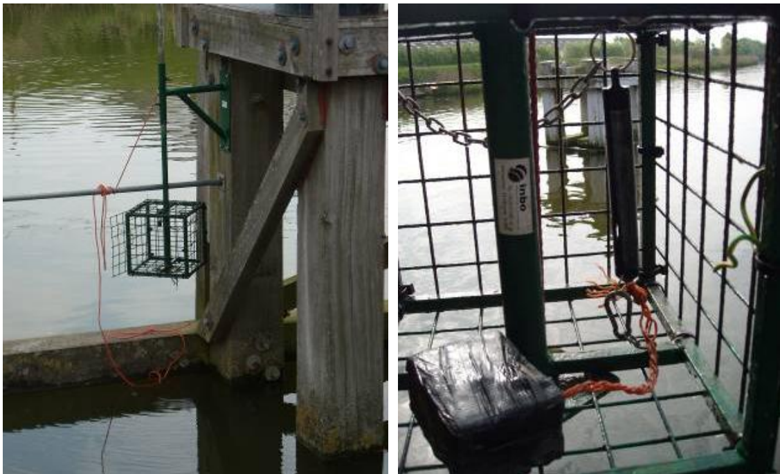
Fig. 14. Monitoringsconstructie van de conductiviteit met behulp van CTD Divers (SWS Technology).
