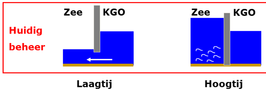
Fig. 5. Schematische voorstelling van het huidige spuibeheer ter hoogte van het Sas Slijkens waarbij glasalen verhinderd worden om het KGO te bereiken.
