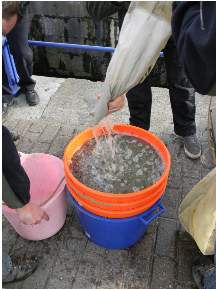
Fig. 12. Drie zeven met een verkleinende diameter op een reservoir.
