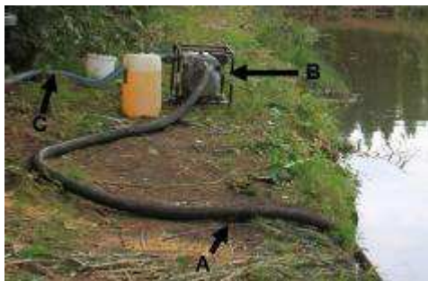
Figuur 67: Vuilwaterpomp. (A) aanzuigbuis + filterkop, (B) Pomp, (C) Afvoerbuis.
