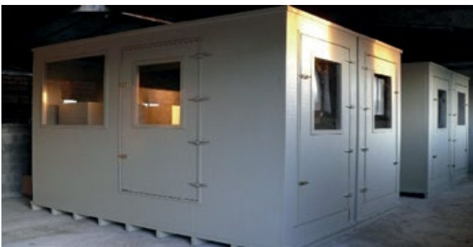
Gasuitwisselingskamer (Bron ILVO)
