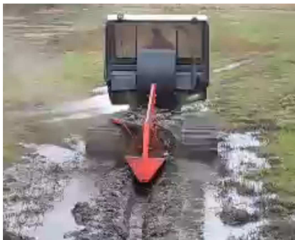
Figuur 8-2. Greppelfrees aan Softrak (moerastractor) van Natuurpunt VZW aan het werk
