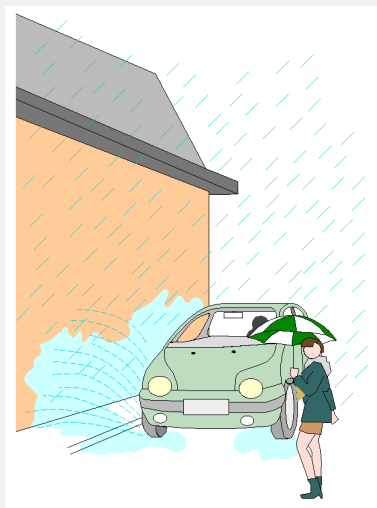
Figuur 10: Regelmatig bespatten van de muurvoet door regenwater of smeltwater (links) kan resulteren in een zichtbaar vochtfront in de muur (rechts).
