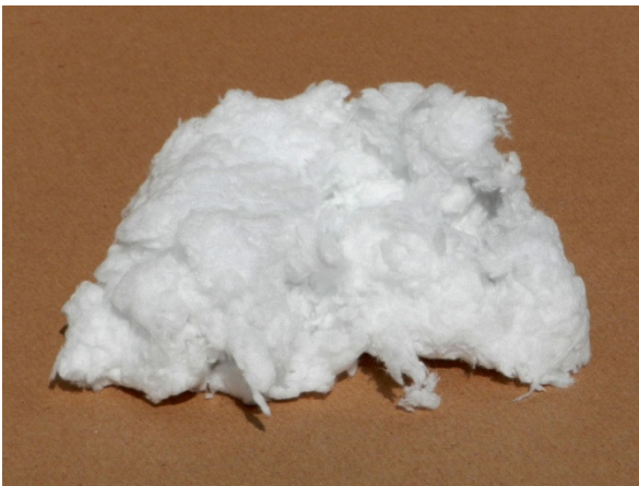
Figuur 34: Minerale wol in de vorm van isolatieplaten, -matten en -vlokken
