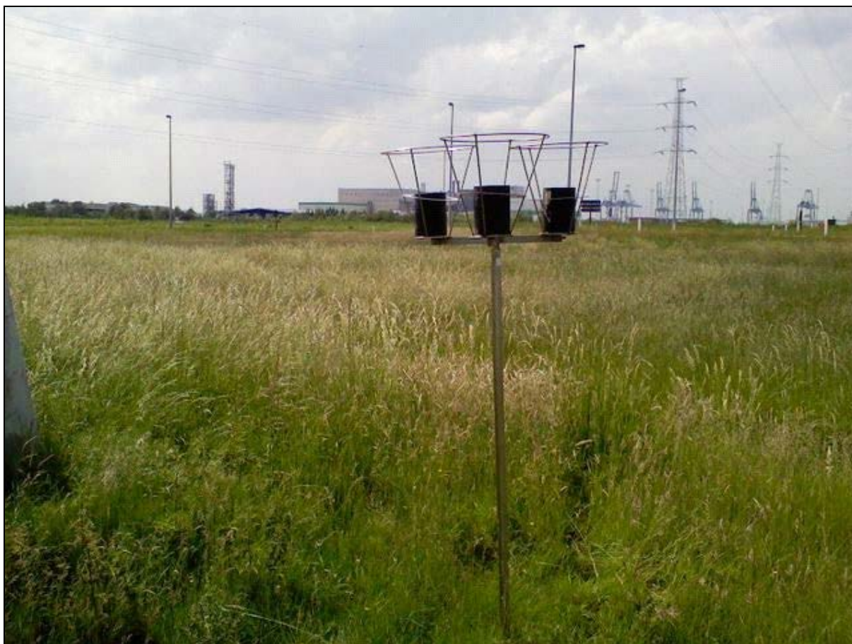
Figuur 3: Meetpost depositie dioxines en PCB's
