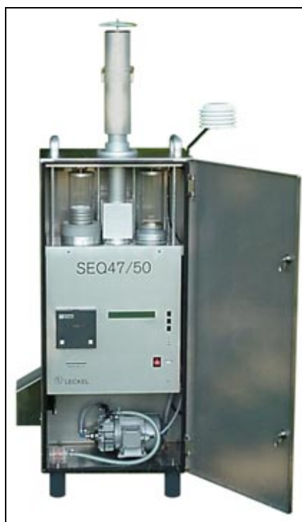
Figuur 21: Leckel SEQ 47/50, het referentietoestel voor de bemonstering van PM 10
