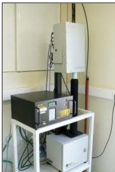
Figuur 3: TEOM-FDMS fijnstof-monitor gebruikt voor zowel PM_{10} - als PM_{2,5} -metingen
