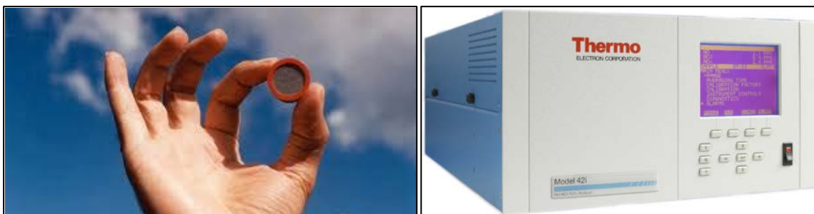
Figuur 6: Passieve sampler voor \text{NO}_2 van het merk IVL (links) en Thermo 42i \text{NO}_x -monitor (rechts)
