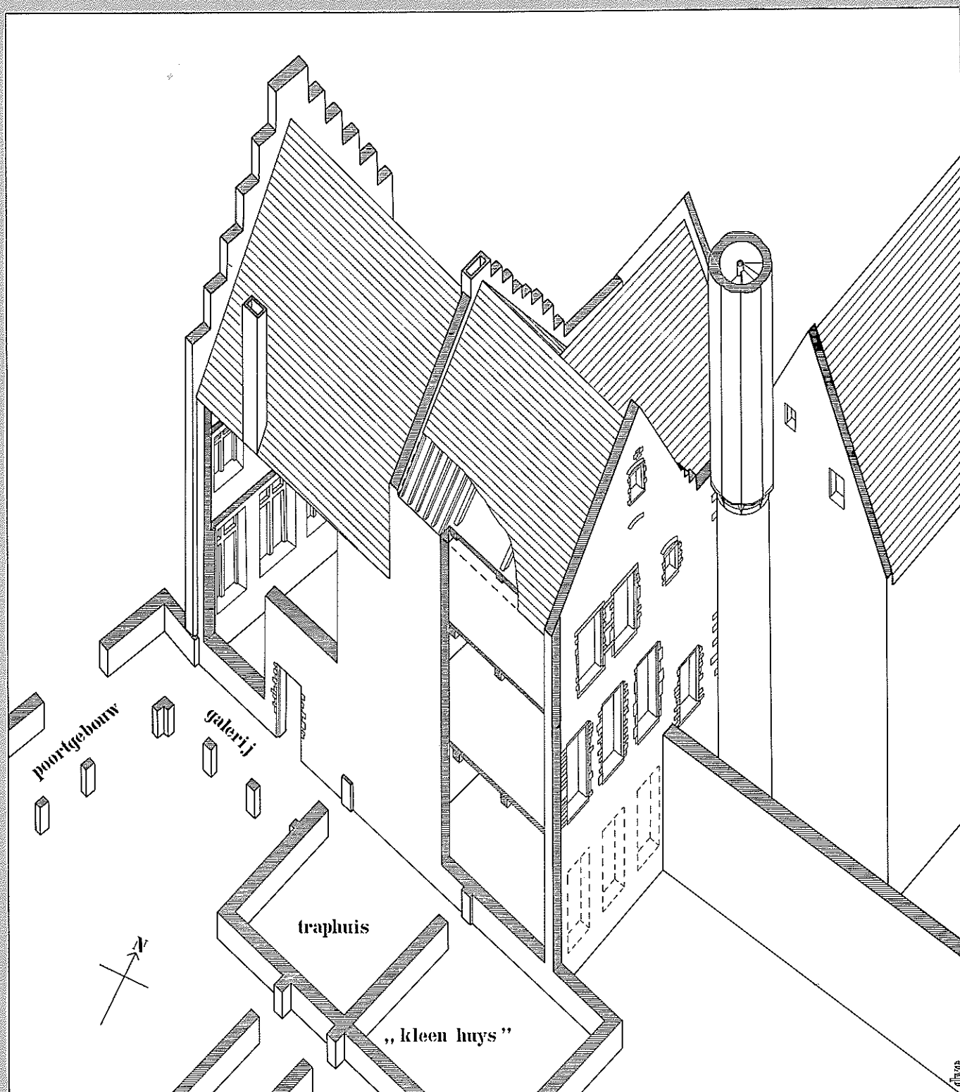
Afb. 9: reconstructie (axonometrie) van het centrale deel van het voormalige Van 't Sestich-complex in de 18de eeuw (tekening auteur)
