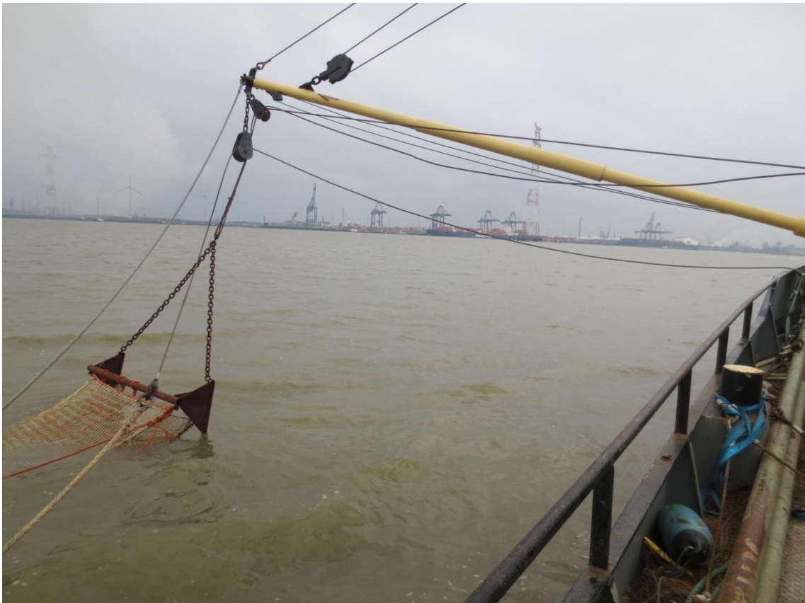
Figuur 4. Het neerlaten van de boomkor (Foto: Jan Breine).
