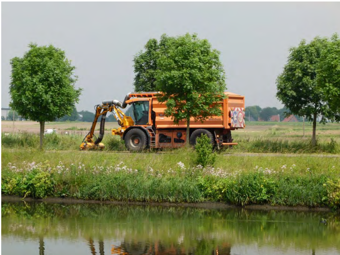
Foto 8: Klepelmaaier met opzuigsysteem aan het werk langs de Leie.
