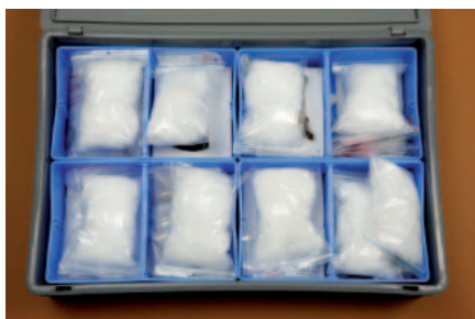
FIG. 9 Glas in een permanente verpakking: de ruimte is opgevuld met polyestervezel in doorgeprikte zakjes
