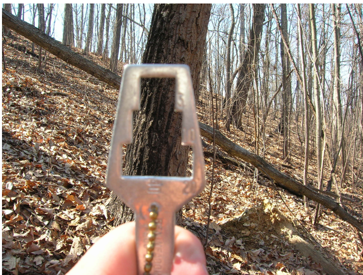
Figuur 3.1: Voorbeeld van de meting van een boom. De boom wordt meegeteld indien een van de twee bovenste openingen gebruikt wordt. De boom wordt niet meegeteld indien de onderste opening gebruikt wordt.
