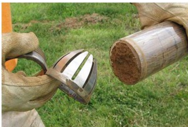
Figuur 8: Liner met ongeroerd monster
