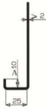
Figuur 10-1-5: rugzijde rechthoekig bord > 1 \text{ m}^2 en \leq 2 \text{ m}^2 ; B = 1500 ; H = 900 (alle maten in mm)
