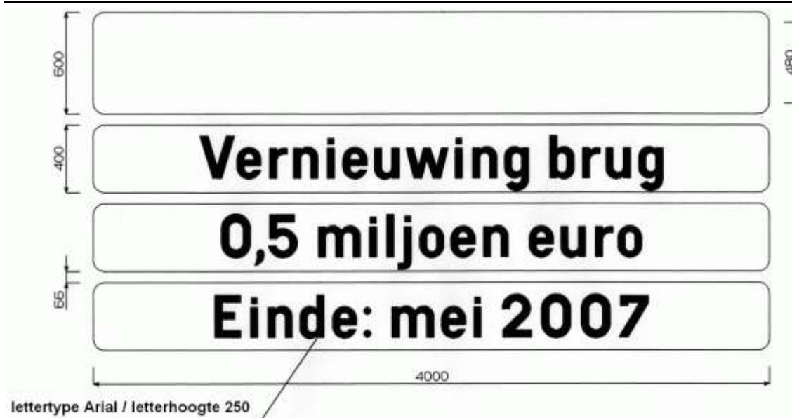
Figuur 10-4-1: werfaankonding voor wegen met een maximumsnelheid van 90 km/h tot 120 km/h
