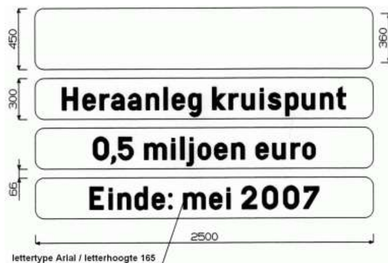
Figuur 10-4-2: werfaankonding voor wegen met een maximumsnelheid tot 90 km/h
