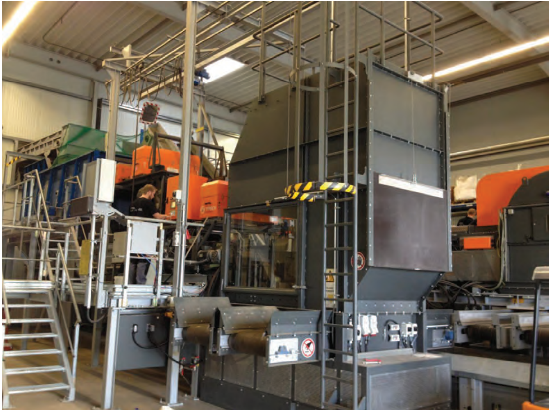
Figuur 29: Sorteerlijn voor “plastics” met ballistische scheider
