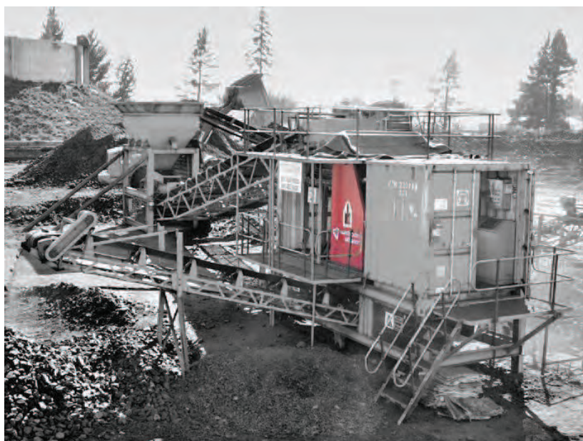
Figuur 31: “NIR in the box” mobiele opstelling voor on-site innovatieve materiaalsortering
