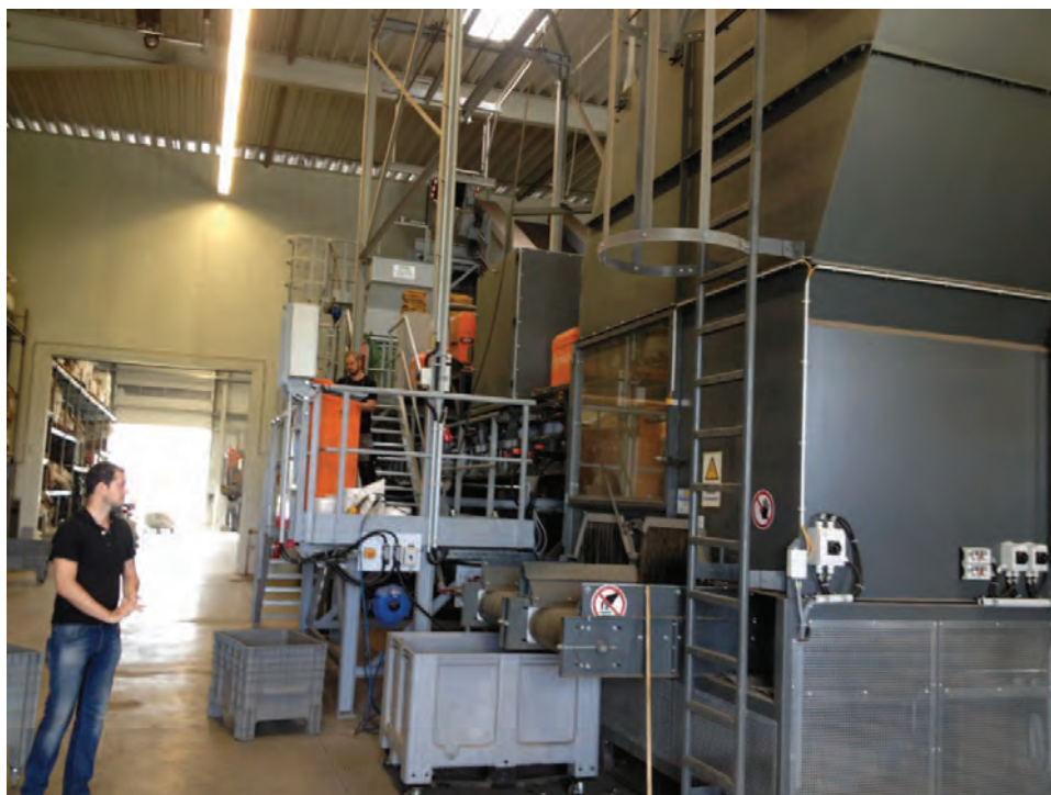
Figuur 30: Sorteerlijn voor "steenfractie"
