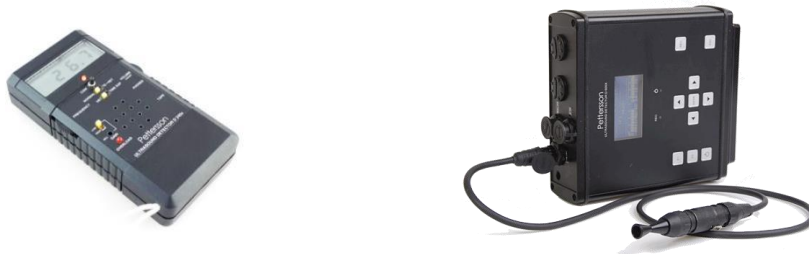
Figuur 2 Voorbeelden van bat-detectors voor onderzoek naar landschapsgebruik (links) en voor het kwantificeren van activiteit per tijdseenheid op vaste punten (rechts).
