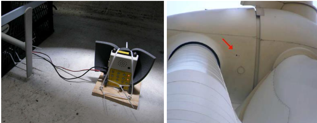
Figuur 6 Voorbeeld van een automatische bat-detector in een windturbine.
