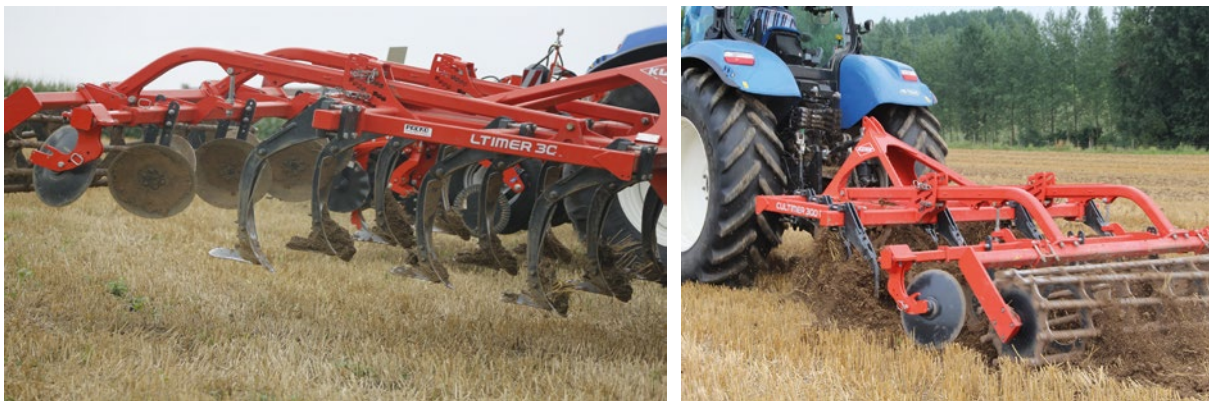
Afbeelding 67 Hybride cultivator uitgerust met vleugelscharen voor het onstoppelen
