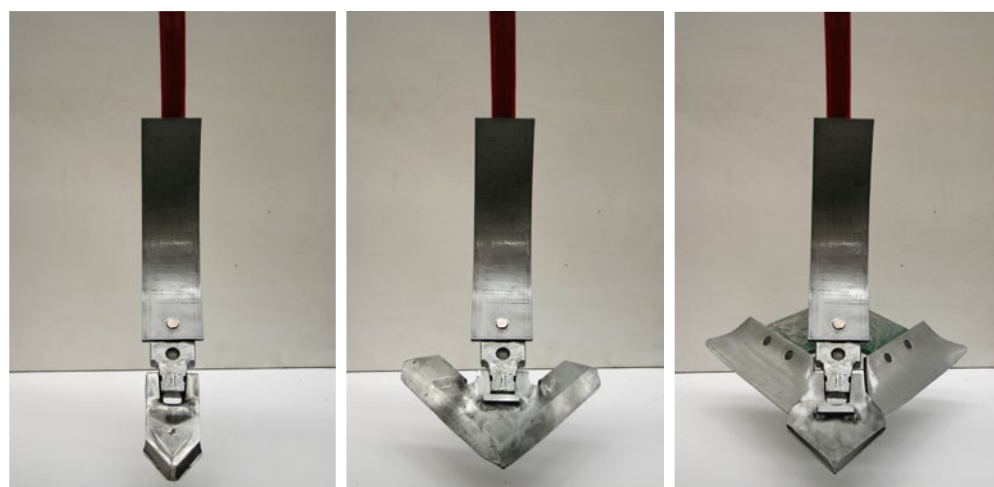
Afbeelding 86 Snelwisselsysteem en bijbehorende scharen (v.l.n.r. beitel-, ganzenvoet- en vleugelschaar)
