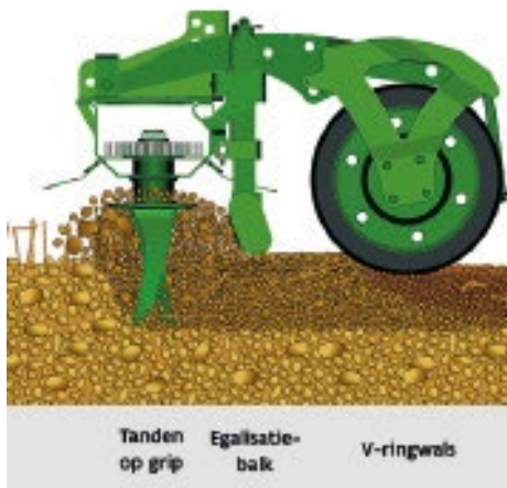
Figuur 9 Rotorkoep met werkende onderdelen
