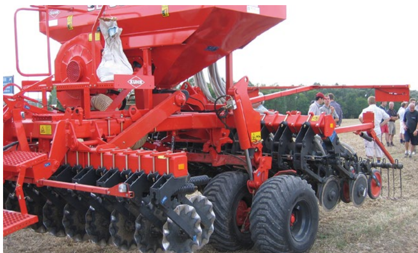
Afbeelding 46 Directinzaaimachine met kartelschijven die de bodem in de lijn van de zaaikouter openmaken. Om in aanmerking te komen voor VLIF steun mag de 'bewerkte strook' maximaal 3 cm breed zijn.
