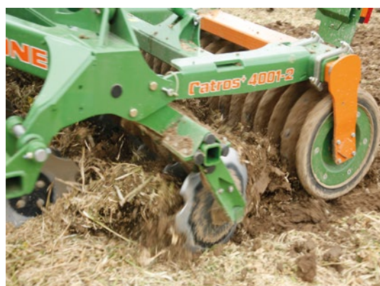
Afbeelding 55 Compact schijveneg met gekartelde schijven en vingereg achter de eerste en achter de tweede rij schijven
