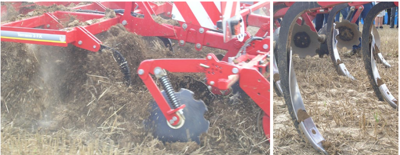
Afbeelding 75 Gebogen tanden met geleidingsplaat; de foto links toont het sterk mengend effect
