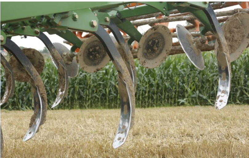
Afbeelding 78 Gewone beitel op hybride cultivator met vaste tanden voor het diepere werk.
