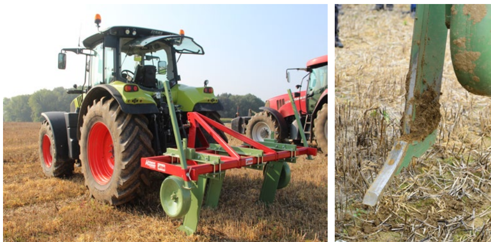
Afbeelding 96 Diepe grondbreker (werking tot 80 cm) met drie rechte tanden voorzien van een beitel. Op twee rijen (in V-vorm) geplaatst
