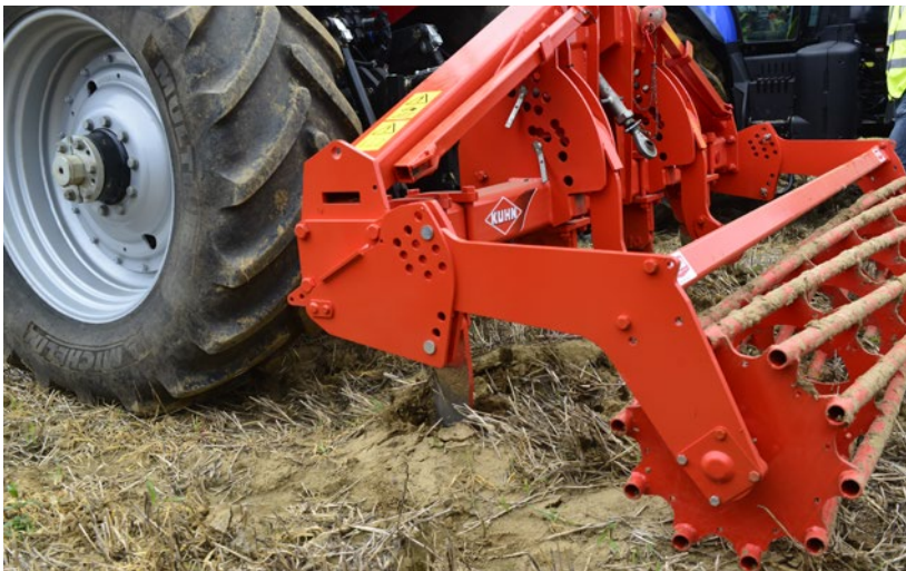
Afbeelding 89 Werking van een grondbreker (zie figuur 8)
