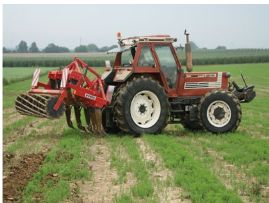
Afbeelding 88 Deelbare vaste tandcultivator: links in gebruik als zware tandcultivator (met beide balken in de grond en tandafstand 31,25 cm); rechts met de rij tanden omhoog, voor gebruik als grondbreker (tandafstand 62,5 cm)
