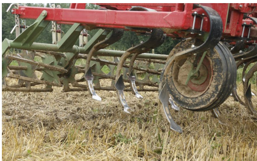
Afbeelding 79 Omkeerbare beitel op stoppelcultivator met verende tanden. Door de bredere vorm hebben deze beitelscharen ook een ontstoppelend effect; op dit model zijn geen vleugelscharen mogelijk
