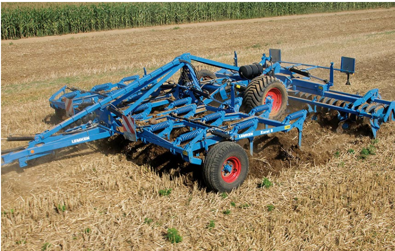
Afbeelding 71 Hybride cultivator met starre tanden en spiraalveerbeveiliging (geveerde starre tanden)
