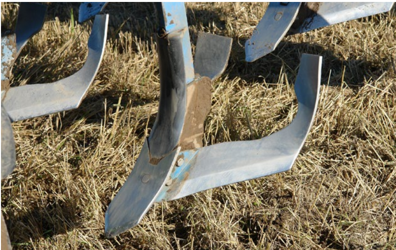
Afbeelding 82 Vleugelschaar met opstaande vleugels voor een zeer intensieve menging
