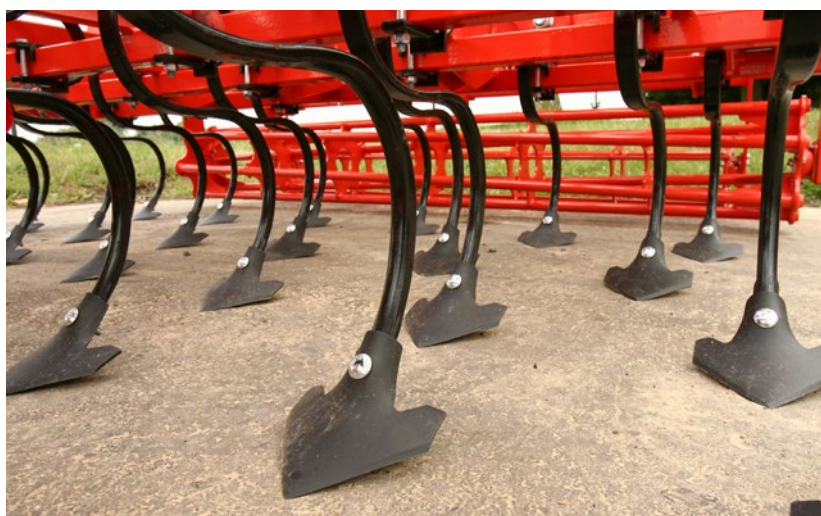
Afbeelding 85 Ganzenvoetscharen op triltanden
