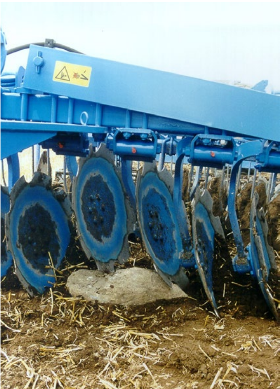
Afbeelding 58 Bodemaanpassing van de afzonderlijke schijfelementen en overbelastbeveiliging
