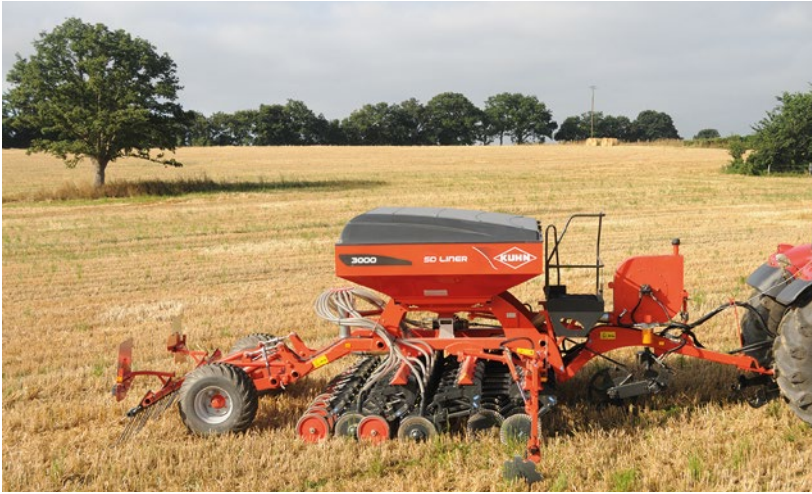
Afbeelding 105 Drieschijvensysteem (één voorsnijschijf en dubbele zaaischijven)
