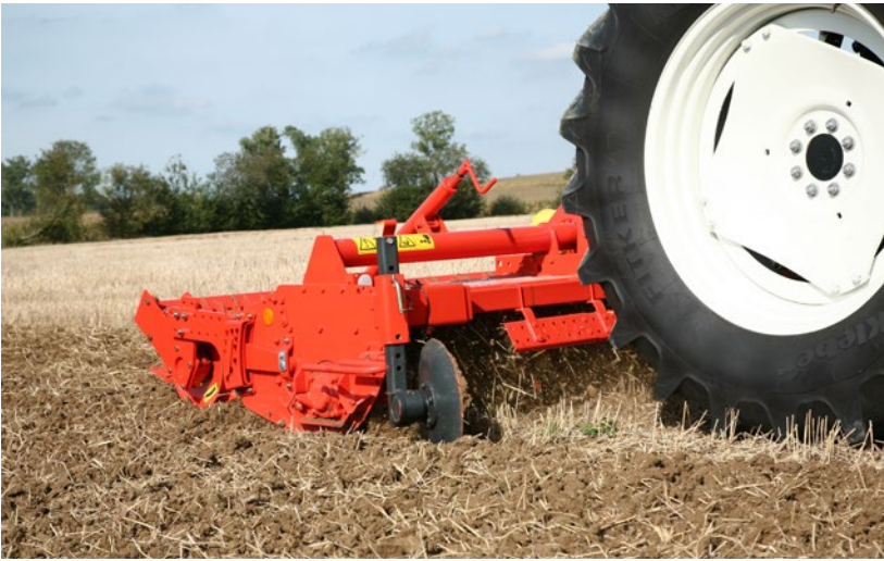
Afbeelding 100 Werking van een grondfrees in de stoppel
