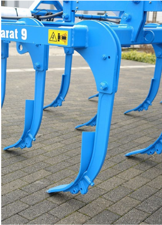
Afbeelding 69 Starre tand met breekboutbeveiliging
