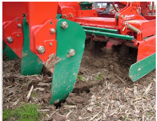
Afbeelding 91 Combinatie van grondbreker en zaai combinatie: de grondbreker wordt gevolgd door een rotorkoepel, een aandrukrol en een zaaimachine.
