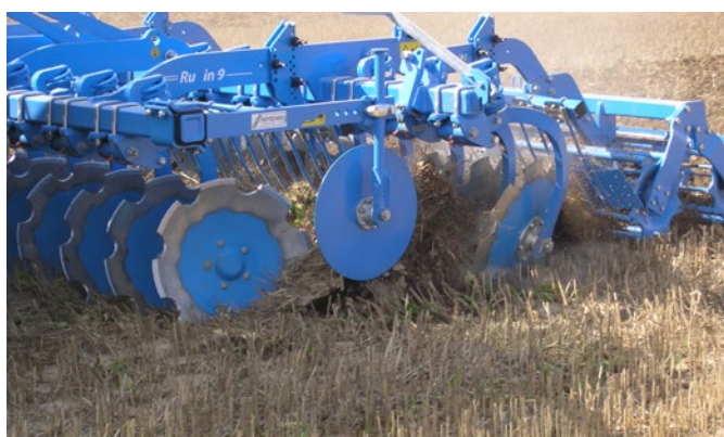
Afbeelding 55 Compact schijveneg met gekartelde schijven en vingereg achter de eerste en achter de tweede rij schijven
