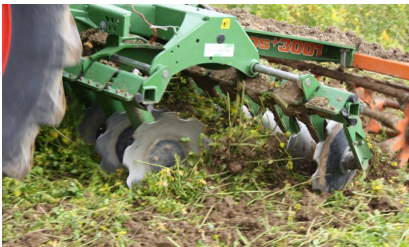
Afbeelding 56 Gebruik van schijveneg voor het inwerken van niet afgevroren groenbedekker in maart
