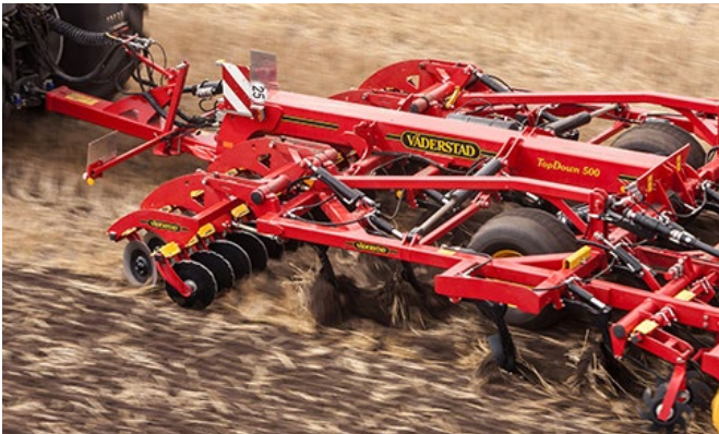
Afbeelding 65 Stoppelcultivator met twee extra rijen schijven voor de tanden. Dit zijn geen egaliserende schijven, maar schijven die werken als een schijveneg.
