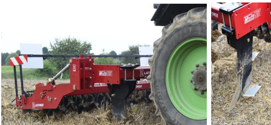
Afbeelding 93 Grondbreker met rechte tanden, gevolgd door gekartelde schijven en aandrukrol; de tanden zijn voorzien van vleugelscharen die geen versmering veroorzaken doordat ze 5 cm boven en op 20 cm van de scherpunt gepositioneerd zijn
