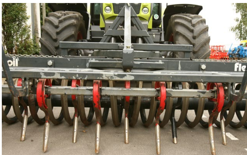
Afbeelding 80 Smalle, stekende beitels op stoppelcultivator met verende tanden, voor werk in harde bodems
