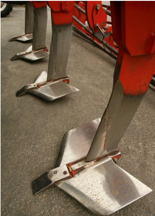
Afbeelding 84 Brede vleugelschaar voor het losbreken op grotere diepte (tot 35 cm).
