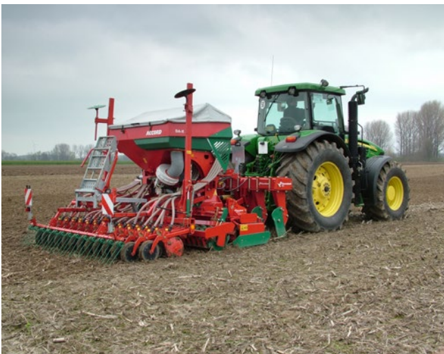
Afbeelding 91 Combinatie van grondbreker en zaai combinatie: de grondbreker wordt gevolgd door een rotorkoepel, een aandrukrol en een zaaimachine.
