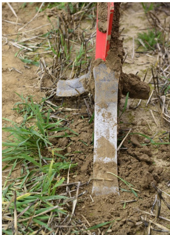
Afbeelding 83 Smalle vleugelschaar met afneembare vleugels. De vleugels kunnen op twee posties (hoogtes) gemonteerd worden, zodat de bodem op twee verschillende dieptes (tegelijk) kan bewerkt worden
