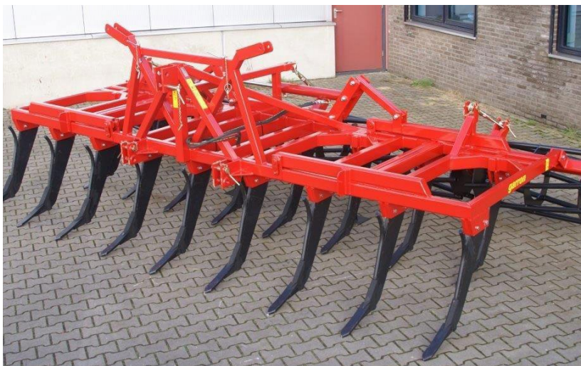
Afbeelding 87 Zware tandcultivator: de tanden staan relatief dicht op elkaar maar deze cultivator is niet geschikt voor een stoppelbewerking; geschikt voor intensief breken tot 40 cm
