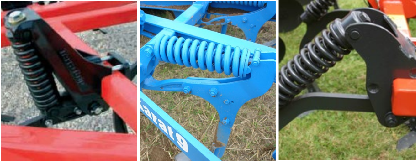
Afbeelding 70 Automatische veerbeveiliging met spiraalveer (geveerde starre tand).
