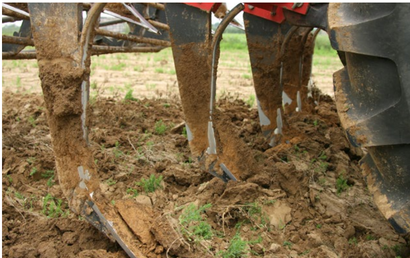
Afbeelding 92 Grondbreker met rechte tanden, onderaan met kleine kromming in de rijrichting; de tand is voorzien van een beitelschaar en een gekromde geleidingsplaat
