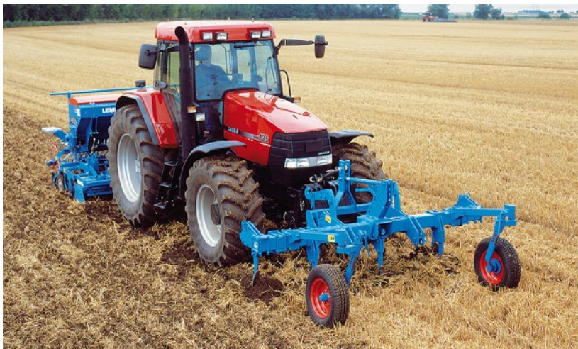
Afbeelding 64 Hybride tandcultivator met afneembare vleugelscharen.
