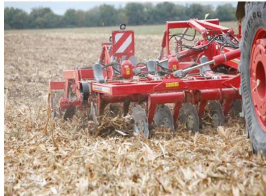
Afbeelding 65 Stoppelcultivator met twee extra rijen schijven voor de tanden. Dit zijn geen egaliserende schijven, maar schijven die werken als een schijveneg.
