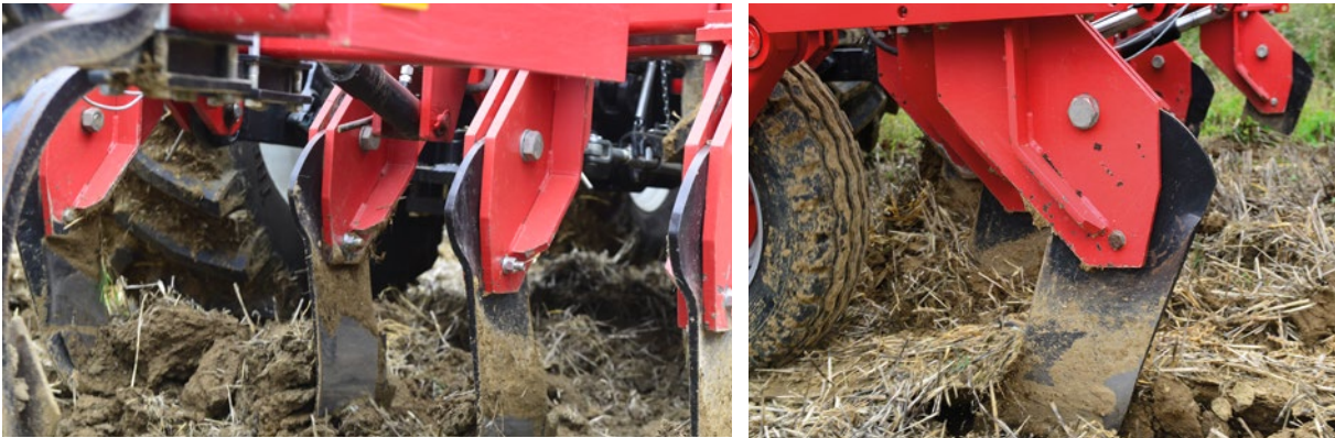
Afbeelding 94 Grondbreker met tanden gebogen in de dwarsrichting (Micheltanden). Rechts ziet u de opheffende en brekende werking van de tand
