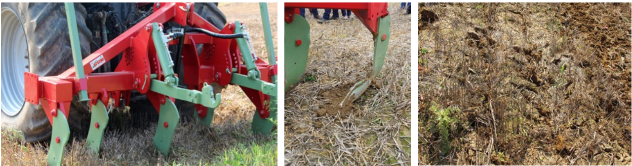
Afbeelding 95 Diepe grondbreker (werking tot 55 cm) met dwars gebogen tanden (Micheltanden). De tanden staan geschrant (voor en achter) op één balk en vormen zo twee rijen voor een betere doorlaat van gewasresten; uiterst rechts ziet u het relatief intact bodemoppervlak na doortocht van de machine
