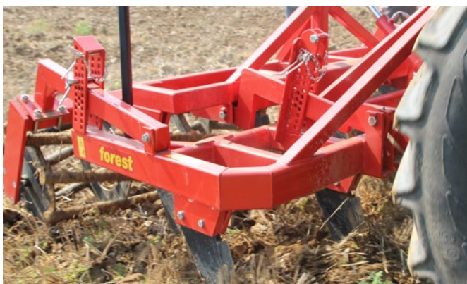
Afbeelding 88 Deelbare vaste tandcultivator: links in gebruik als zware tandcultivator (met beide balken in de grond en tandafstand 31,25 cm); rechts met de rij tanden omhoog, voor gebruik als grondbreker (tandafstand 62,5 cm)
