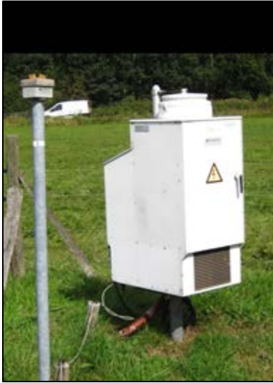
Figuur 6: Voorbeeld van een natte depositievanger of wet-only sampler
