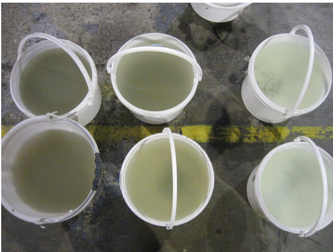
Figuur 40: Opgepompt water tijdens overpompen van peilbuis P869 op site 3 te Dendermonde
