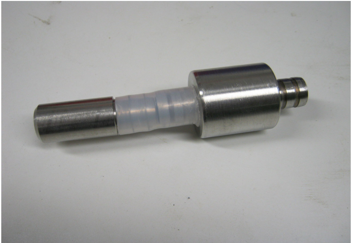
Figuur 5: Ontwerp 'Surge Block' met hierop bevestigd een knikkerpuls ter afpompings van water en vrijgezet slib
