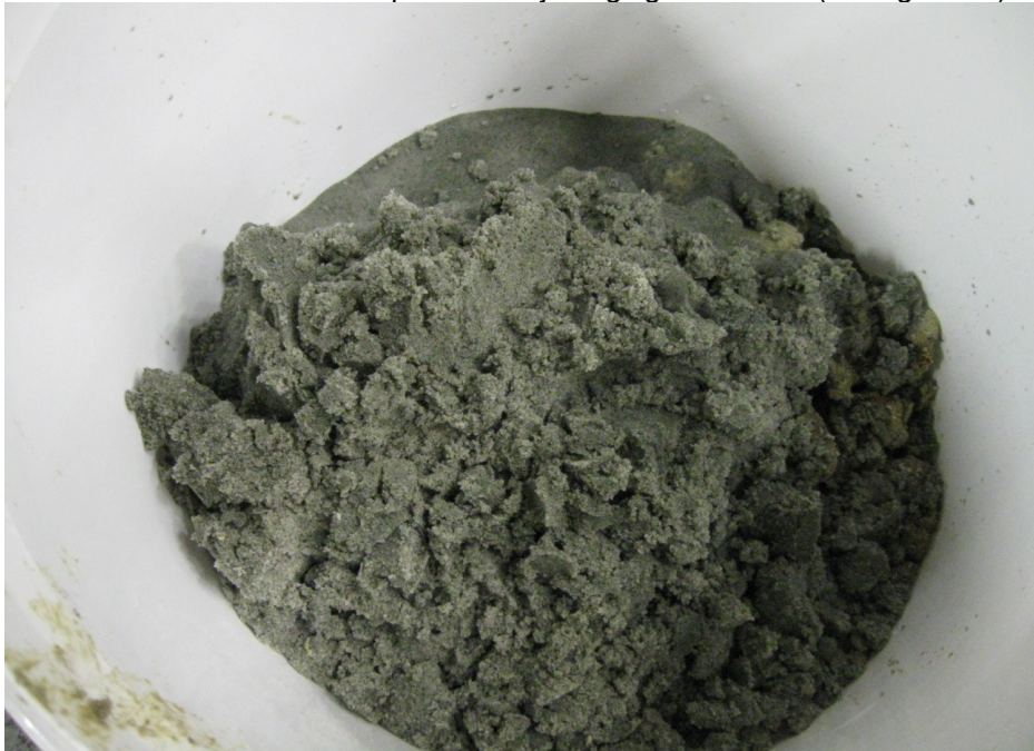
Figuur 42: Zand dat tijdens het helderpompen van P868 onttrokken werd
