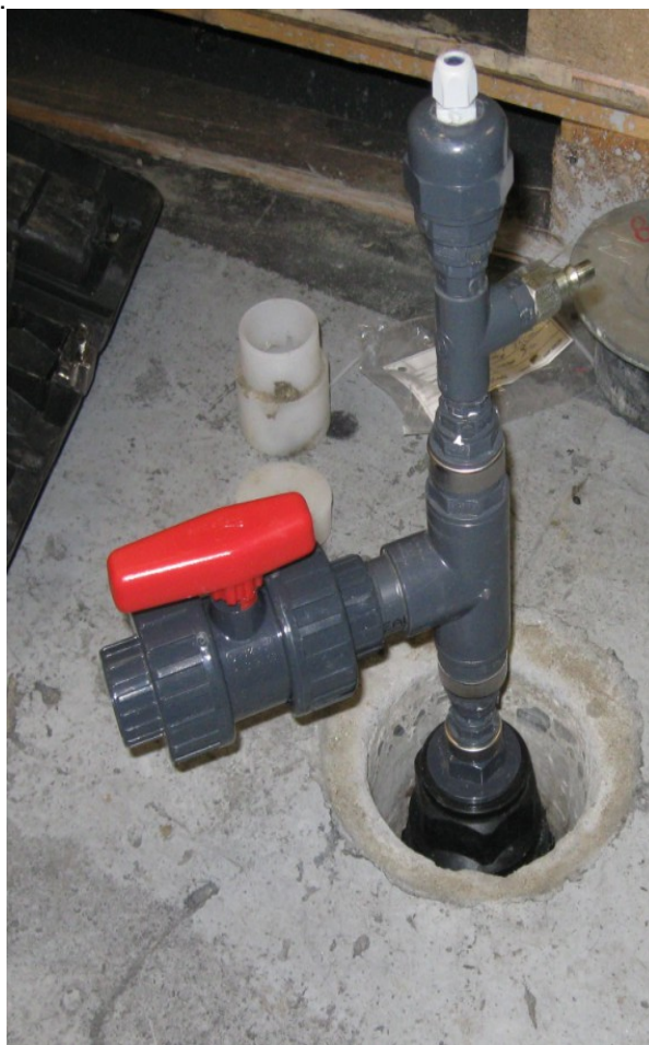
Figuur 7: Kopstuk voor peilbuisontwikkeling door middel van jutten
