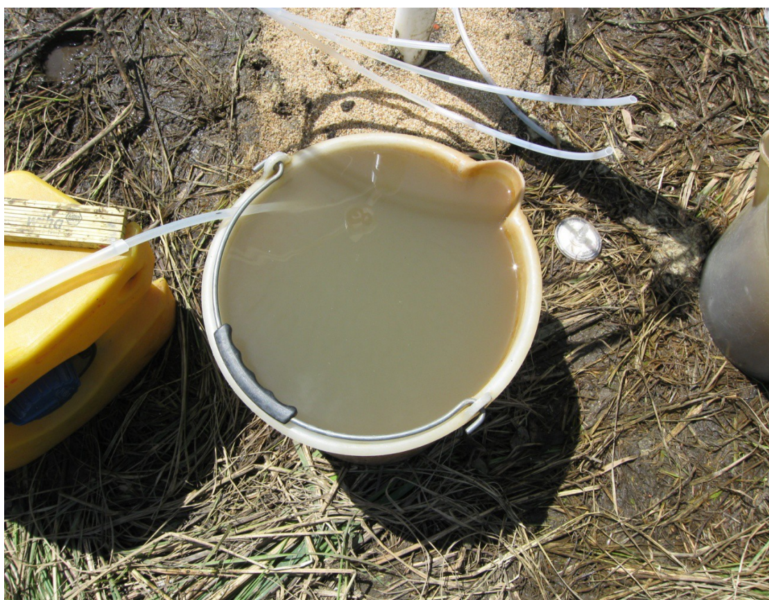
Figuur 9: Opgepompt water tijdens overpompen van peilbuis P-O3 op site 1 te Antwerpen
