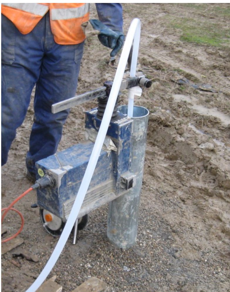
Figuur 26: Gemotoriseerde kogelkleppomp ('ja-knikker')
