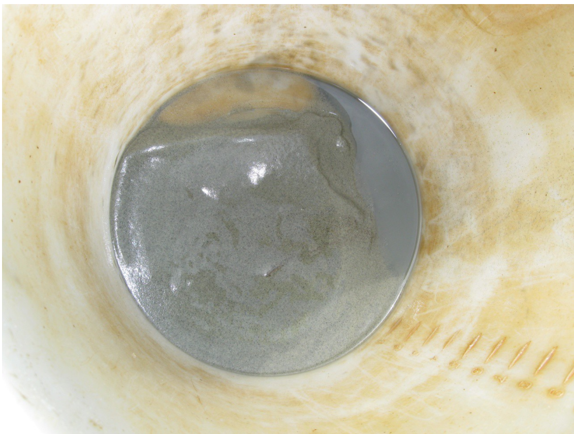
Figuur 11: Zand onttrokken tijdens de eerste toepassing van 'mechanical surging' in P-O4 (foto in emmer genomen)
