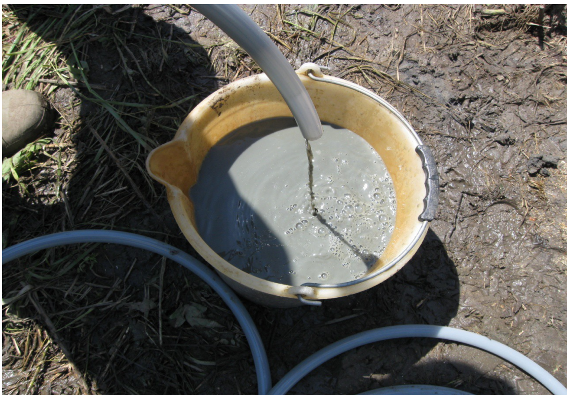
Figuur 10: Opgepompt water tijdens 'Mechanical Surging' in peilbuis P-O4 op site 1 te Antwerpen
