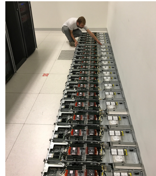
Afbeelding 3: De nog bruikbare hardware van de Tier-1a in Gent werd uitvoerig gereviseerd en herwerkt tot cloud proefopstelling.
