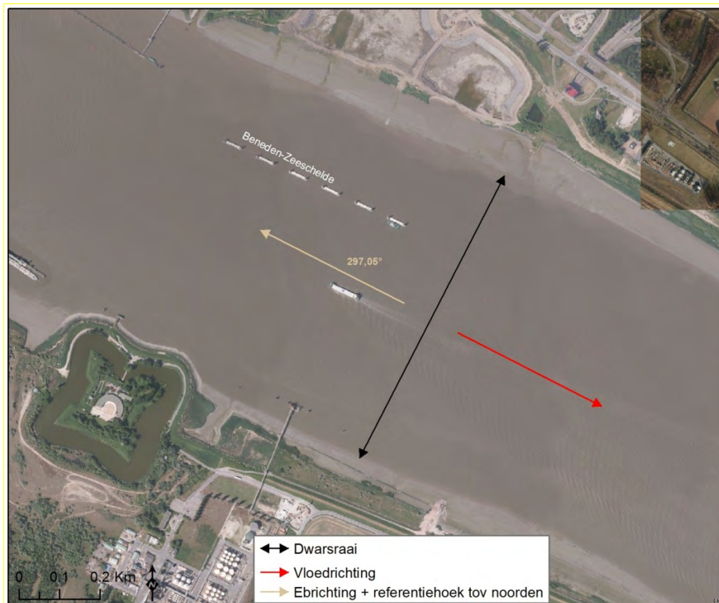
Figuur 185 - Meetraai voor de dertienuursmeting te Liefkenshoek (Beneden-Zeeschelde)
