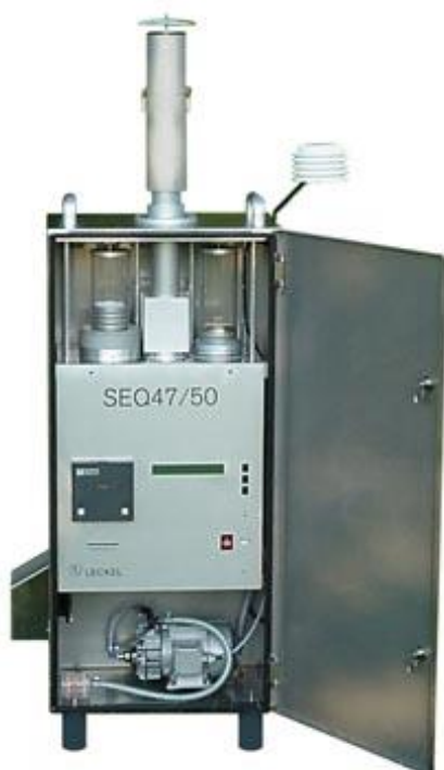
Figuur 16: Leckel SEQ 47/50, het referentietoestel voor de bemonstering van PM_{10}
