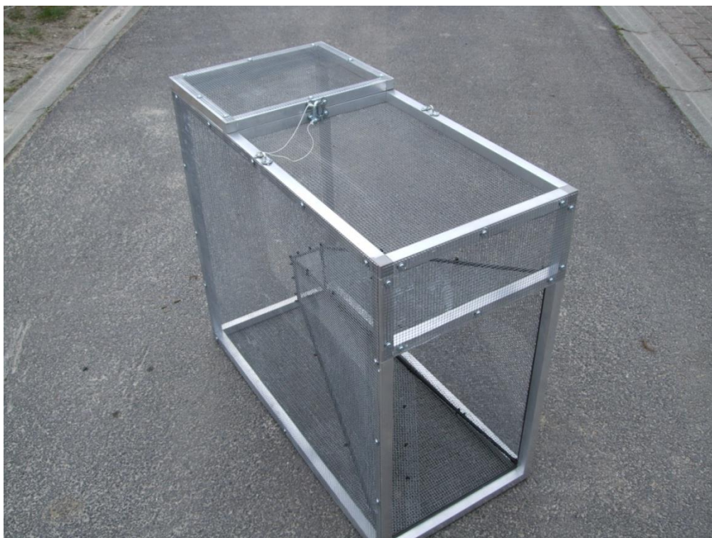
Figuur 4: De vangkooi die in een compartiment van 'de Wit' visdoorgang geplaatst wordt.
