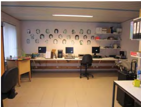
Computerruimte, opgebouwd door een vrij hangend werkblad waar rolstoelgebruikers vlot onder kunnen. Stijn vzw, © Inter
