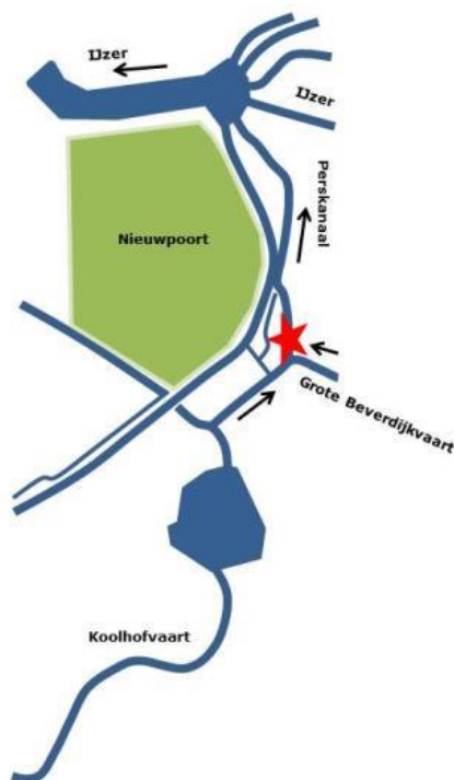
Figuur 4 Situering van het studiegebied. Het pompemaal van Veurne-Ambacht (rode ster) regelt de afwatering van de Koolhofvaart en de Grote Beverdijkvaart. Overtollig polderwater wordt bij afgaand getij doorheen het Afvoerkanaal Veurne-Ambacht (Perskanaal) via het spuicomples van de Ganzepoot in de getijgeul van de IJzer geloosd.
