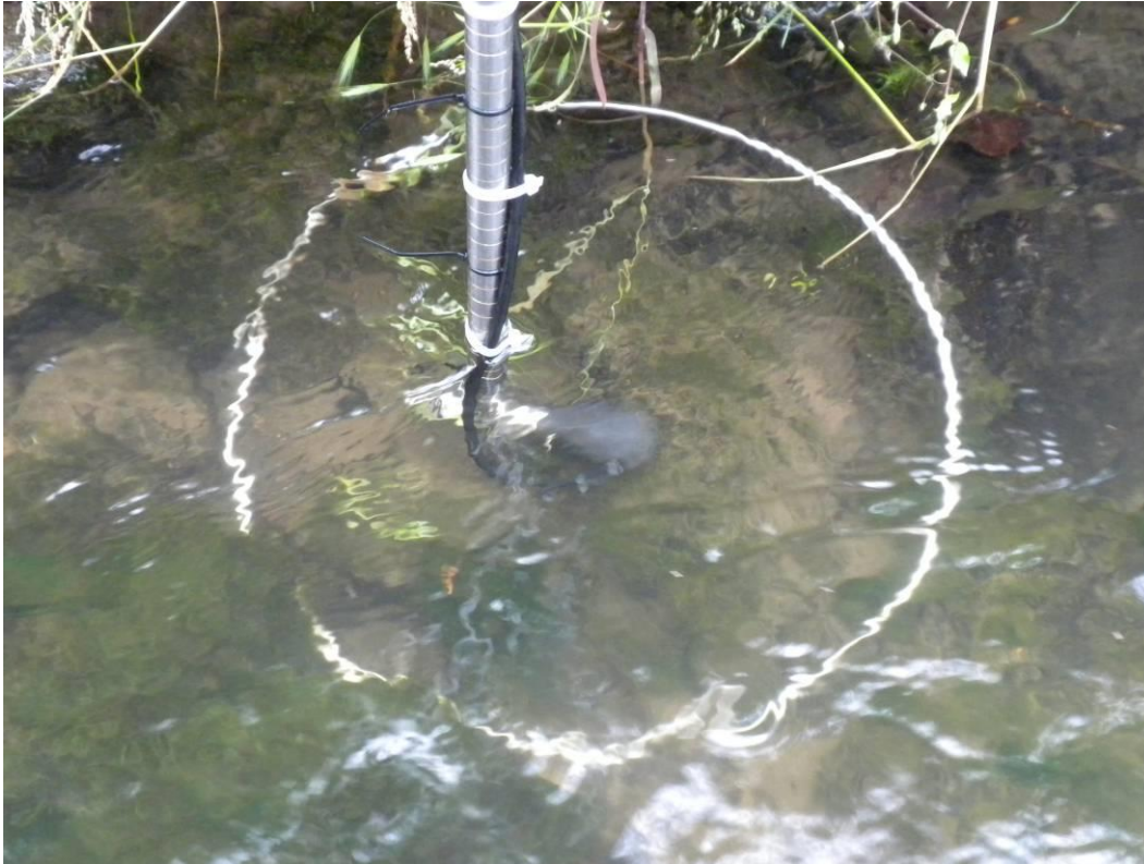
Figuur 77 Metalen ring met diameter van 40 cm waarbinnen in elk meetpunt de stroomsnelheid, waterdiepte en ingebedheid van het substraat worden ingeschat.
