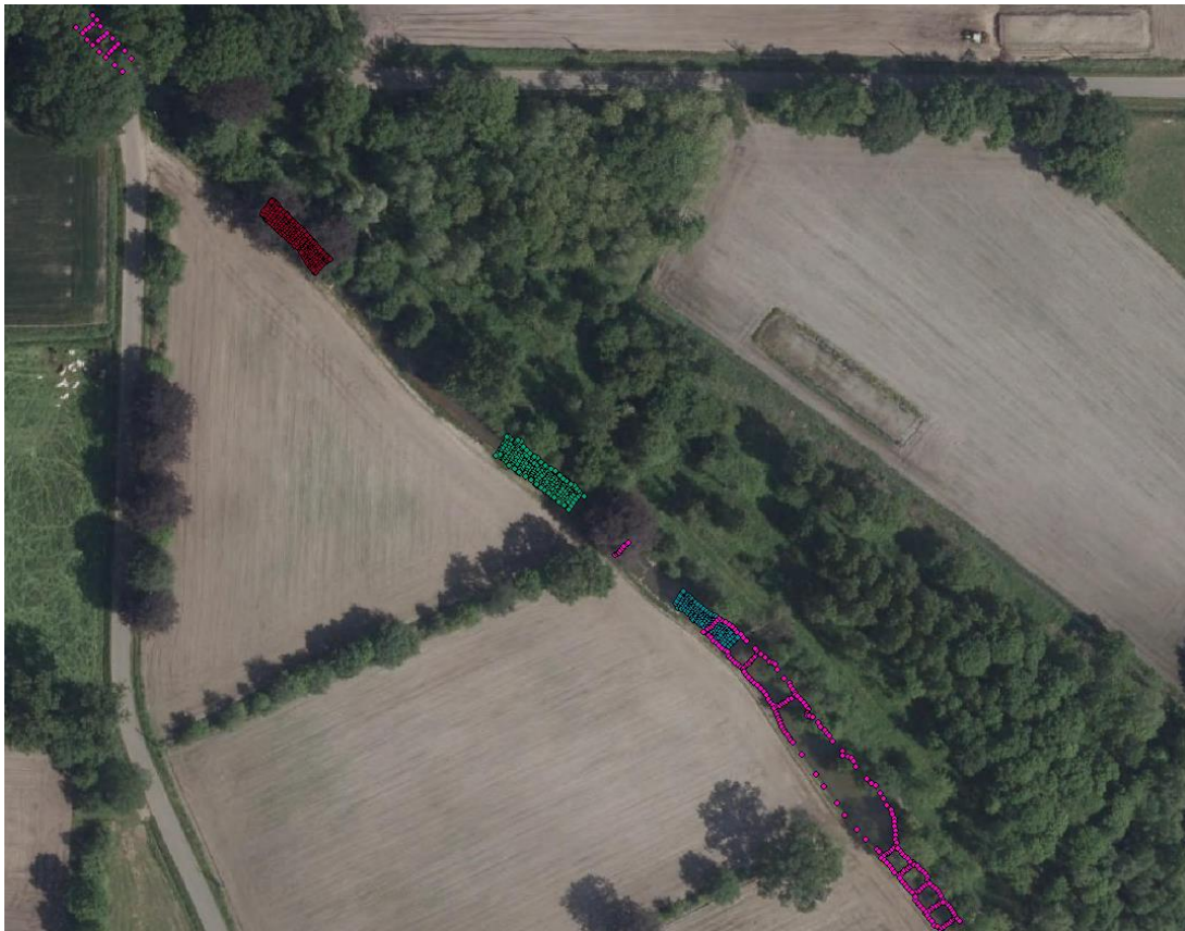
Figuur 97 Locatie van de riffles die werden opgemeten met de trimble in 2013, voor de aanleg van de vistrap en nieuwe grindbedden (donker rode, groene en blauwe punten) en de opmeting in 2014, na de aanleg van de vistrap en nieuwe grindbedden (roze punten).
