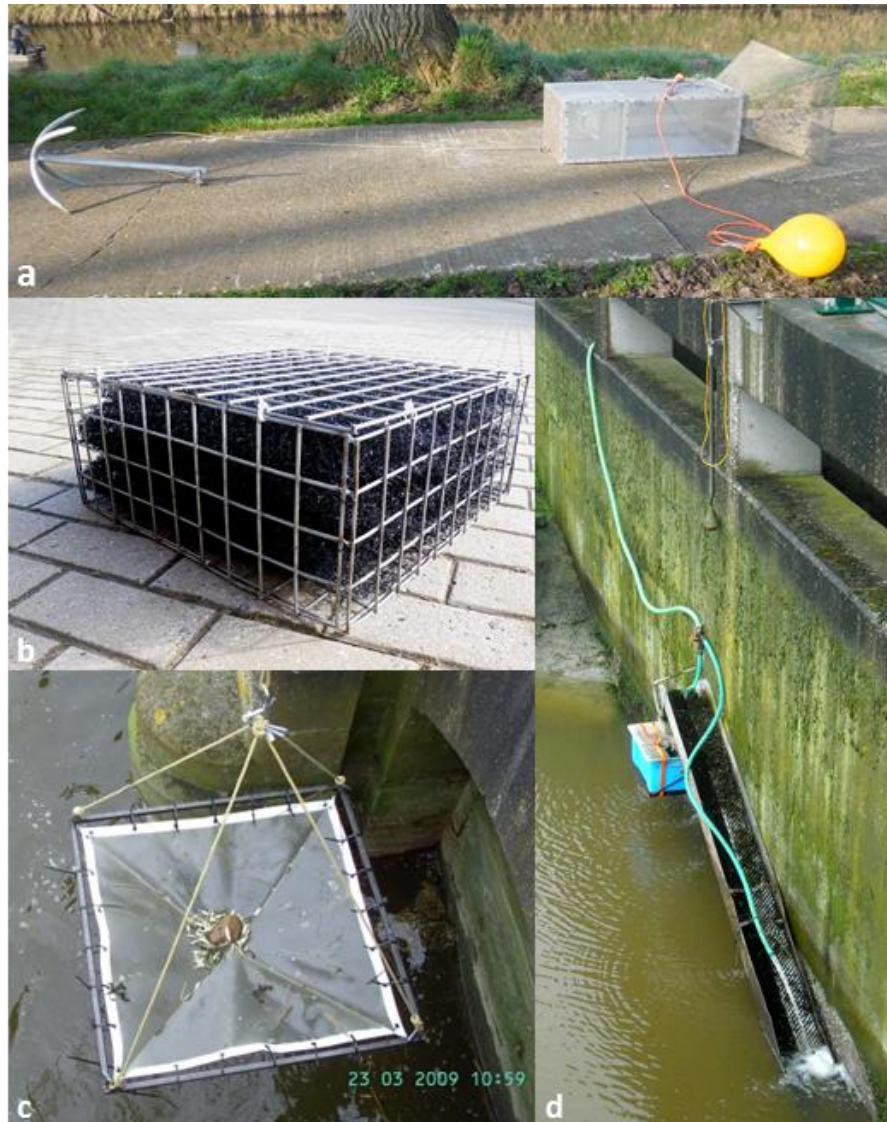
Figuur 9 Overzicht van de diverse vangstconstructies die in het Afvoerkanaal werden toegepast om glasaalmigratie te kwantificeren. (a) glasaalkooi, (b) artificieel substraat ('flottang'), (c) kruisnet en (d) palinggoot. (foto © 2009/2013/2016 INBO)
