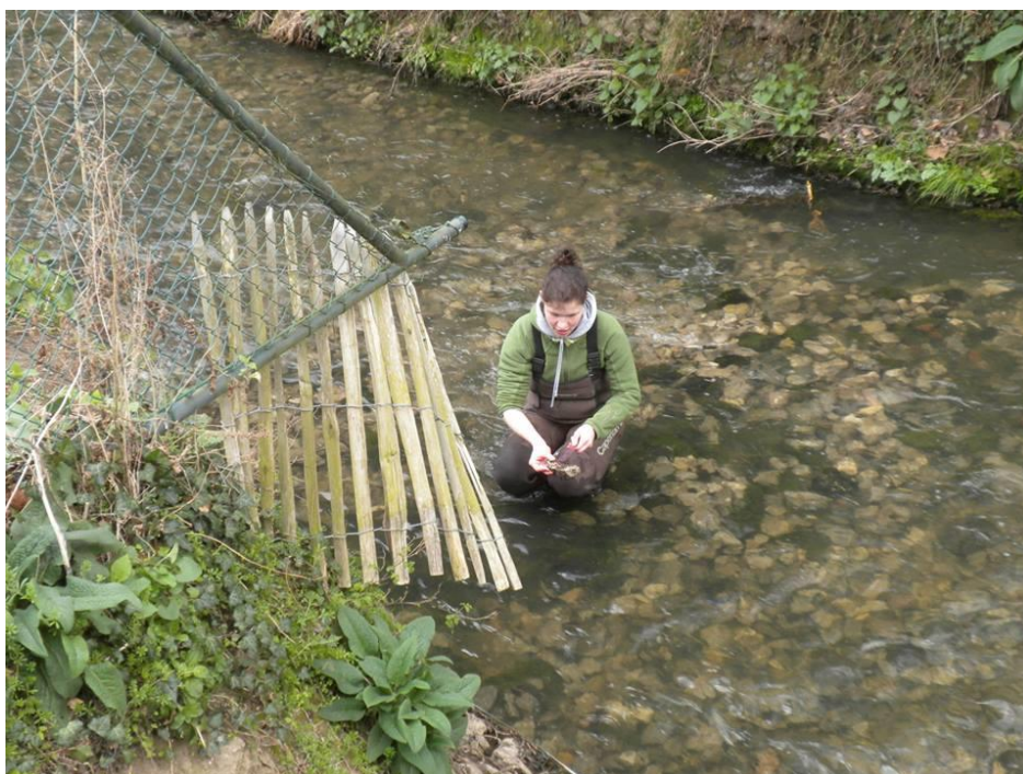
Figuur 94 Foto van de nieuw aangelegde riffle stroomafwaarts van de Elsenstraat (Neerijse) tijdens de veldmeting van 25 april 2014.
