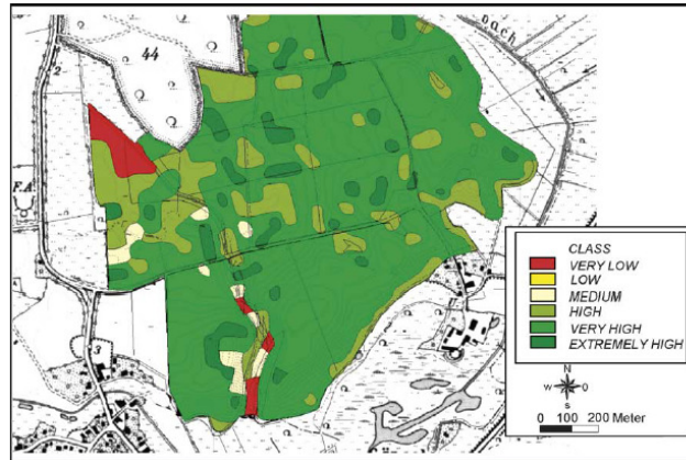
Figuur 1-21 Berekende waarden voor de precompressiestress (kPa) bij een pF van 1,8 op bedrijfsniveau voor morene-ondergrond (30-60 cm) in Duitsland. Klassificatie van de precompressiestress (kPa): <30, zeer laag; 30-60, laag; 60-90, medium; 90-120, hoog; 120-150, zeer hoog; >150, extreem hoog (Horn et al., 2005).
