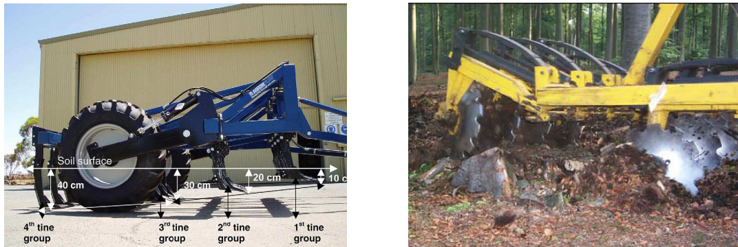
Figuur 1-14 Links: een werktuig van de nieuwe generatie voor de decompactie van de diepere bodemlagen op landbouwgrond (Hamza en Anderson, 2005); Rechts: een schijveneg voor het losmaken van de bovenlaag van bosbodems (De Vos, 2005).
