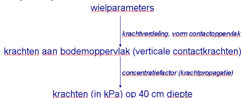
Figuur 2-7 Schematische weergave van de berekeningen in SoilFlex
