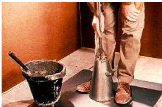
Figuur 5: Consistentieproef met kegel waarbij de inzakking wordt gemeten (bron: Febelcem)
