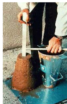
Figuur 5: Consistentieproef met kegel waarbij de inzakking wordt gemeten (bron: Febelcem)
