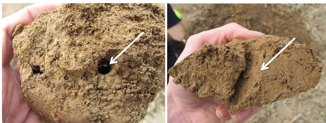
Figuur 5.10 Voorbeeld van een grote doorgaande macroporie aanwezig in de verdichte ondergrond (perceel Ah1 te Gavere), met links een bovenaanzicht en rechts een dwarse doorsnede
