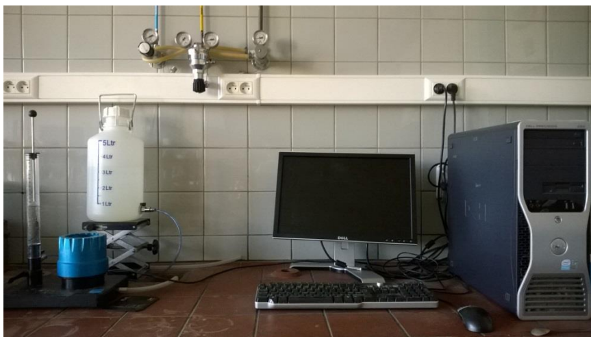
Figuur 4.3 Opstelling ter bepaling van de verzadigde doorlatendheid met het KSAT-toestel (©UGent).
