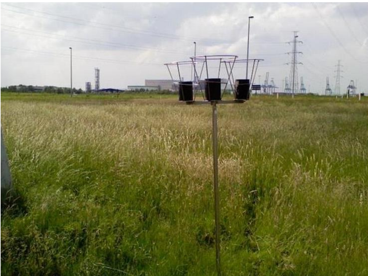
Figuur 3: Statief voor monsternamen depositie dioxines en PCB's
