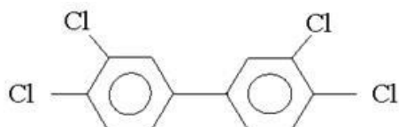
Figuur 2: Chemische formule van een PCB-verbinding
