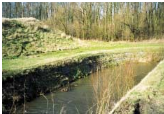
Onder: oeververdediging, zoals hier gebeurde met betonplaten, is ecologisch gezien zeker te vermijden.
