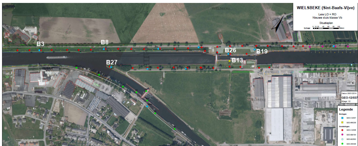
Figuur 4 – Uitgevoerd grondonderzoek in de omgeving van de nieuwe sluis te Sint-Baafs-Vijve.
