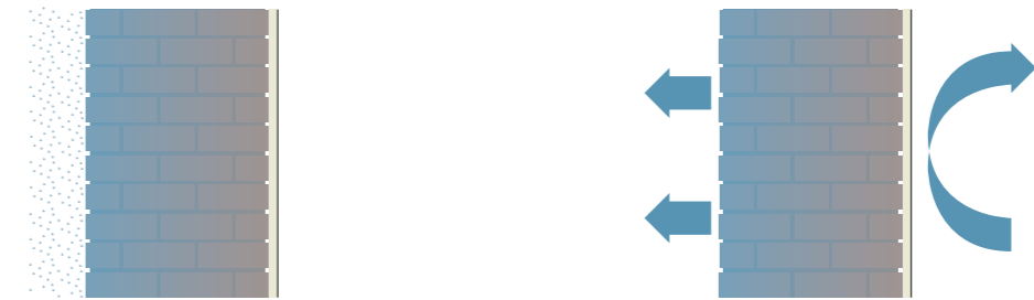
figuur 5: verminderde droging van het metselwerk
