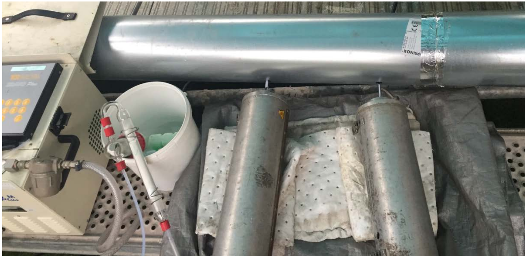
Figuur 13: Opstelling bemonsteringstrein voor PAK (links) en filter voor stofmassa, levoglucosan en OC/EC (rechts)
