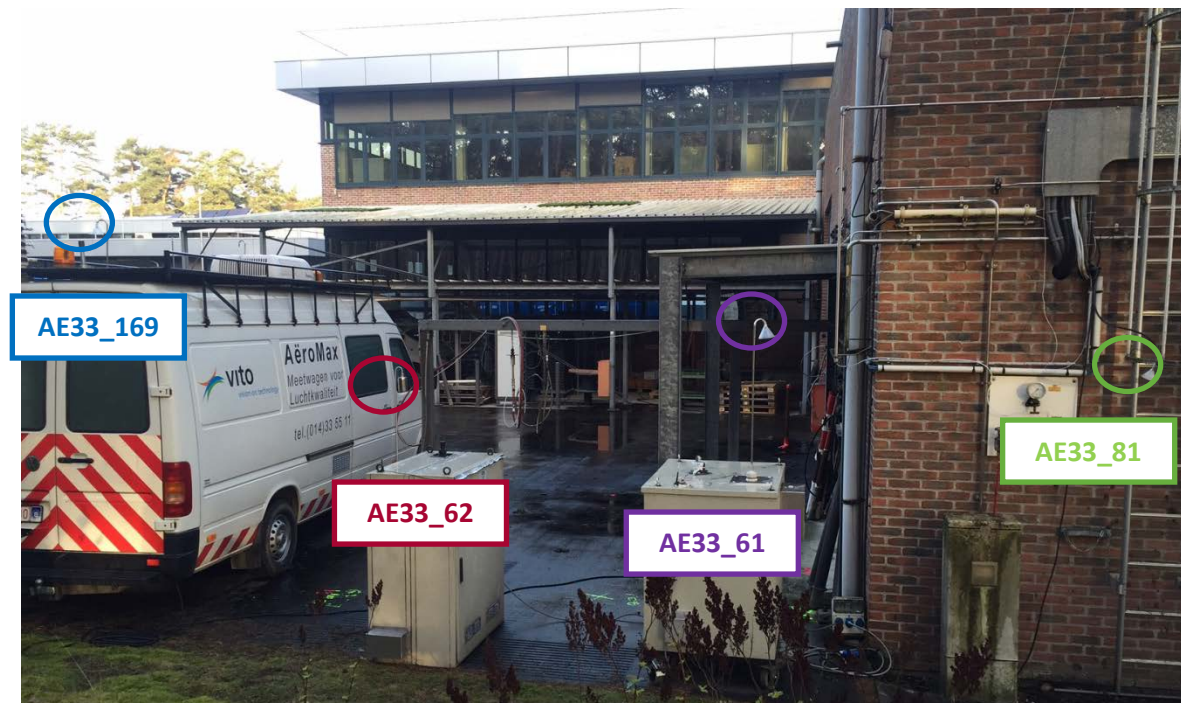
Figuur 7: Opstelling tijdens de vergelijkende metingen op locatie E na de meetcampagne
