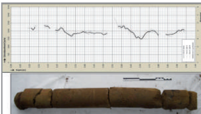
Figuur 10: Geluidssnelheidsmetingen op kernboring van de Langenberg te Diest (foto KIK).
