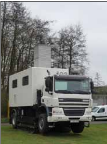
Fig. 6: De sondeerwagen van de afdeling Geotechniek wordt ingezet bij het onderzoek naar de grondgesteldheid.
