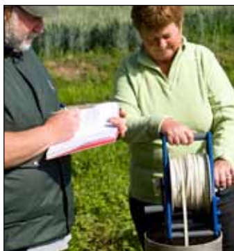
Fig. 7: Uitvoeren van een peilmeting met behulp van een peillint in een put van het primaire meetnet.
