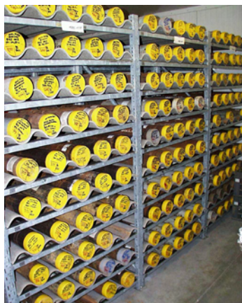
Fig.6: Bewaring van boringen in de vochtkamer bij de afdeling Geotechniek.
