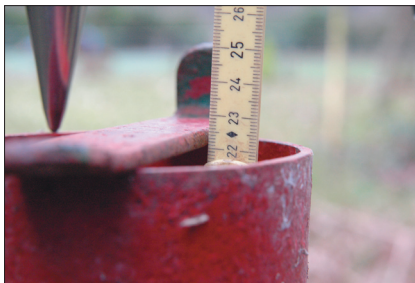
Fig. 3: opmeten van de hoogte van de peilfilters t.o.v. de beschermhuis.
